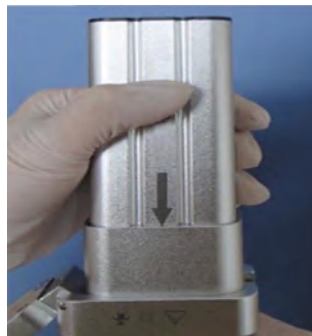
Рис.18 Вставка аккумуляторной батареи внутрь рукоятки корпуса электропривода
