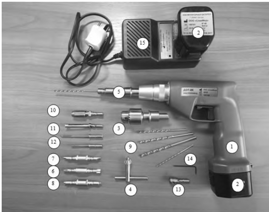
Рис.1 Электродрель ДЭТ-06: 1-электропривод, 2-аккумуляторная батарея 7,2В, 3-патрон универсальный, 4-ключ к универсальному патрону, 5-патрон быстросъемной, 6-отвертка крестовая, 7-отвертка плоская, 8-отвертка шестигранная, 9-набор сверл, 10-патрон для спиц, 11-фреза полая, 12-набор метчиков для кортикальной резьбы, 13- адаптер для сверла, 14-отвертка технологическая, 15-зарядное устройство 220/ 7.2В.
