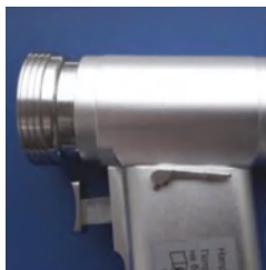
Рис. 19. Рычаг для извлечения аккумуляторной батареи из разъема
