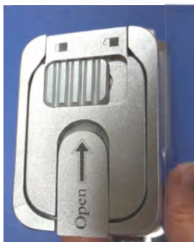
Рис. 28. . Снятие блокировки и фиксации крышки рукоятки корпуса
