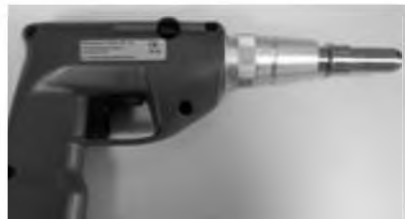
Рис.22. Установка быстрозажимного патрона
