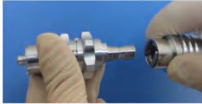
Рис. 21. Установка адаптера автостопа
