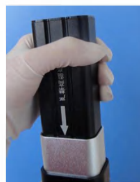
Рис.8 Снятие фиксации крышки рукоятки Рис.9 Установка батареи внутри рукоятки
