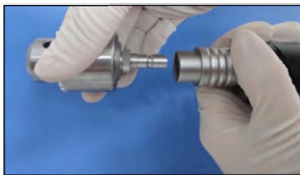
Рис. 19. Установка универсального патрона
