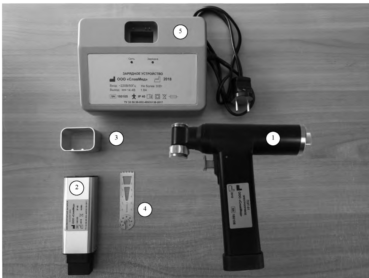
Рис.1 Электропила ПЭТ-01. 1-электропривод с винтовым зажимом, 2-аккумуляторная батарея, 3-асептический переходник, 4-полотно секторное, 5- зарядное устройство 220/14.4В.
