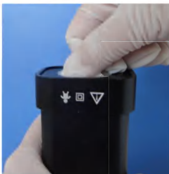
Рис.15 Снятие фиксации крышки рукоятки
