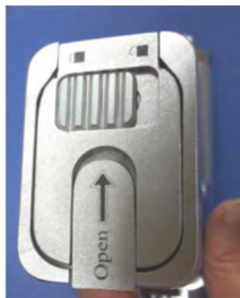
Рис. 17. Снятие блокировки и фиксации крышки рукоятки корпуса
