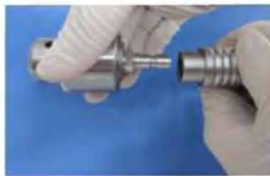
Рис. 33. Установка универсального патрона
