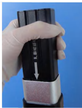
Рис. 17 Установка батареи внутрь рукоятки
