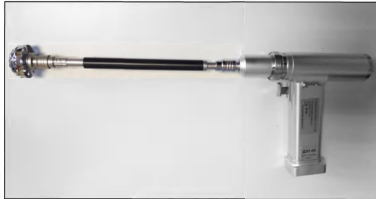
Рис. 403. Установка фрезы с адаптером в зажимное устройство насадки ример.
