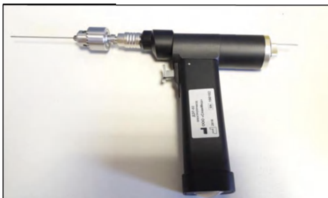
Рис.20. Фиксация спицы в универсальном патроне
