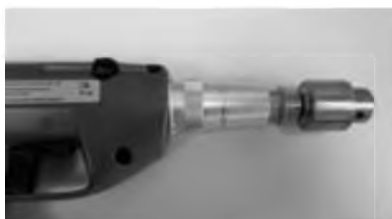
Рис. 21. Установка универсального патрона
