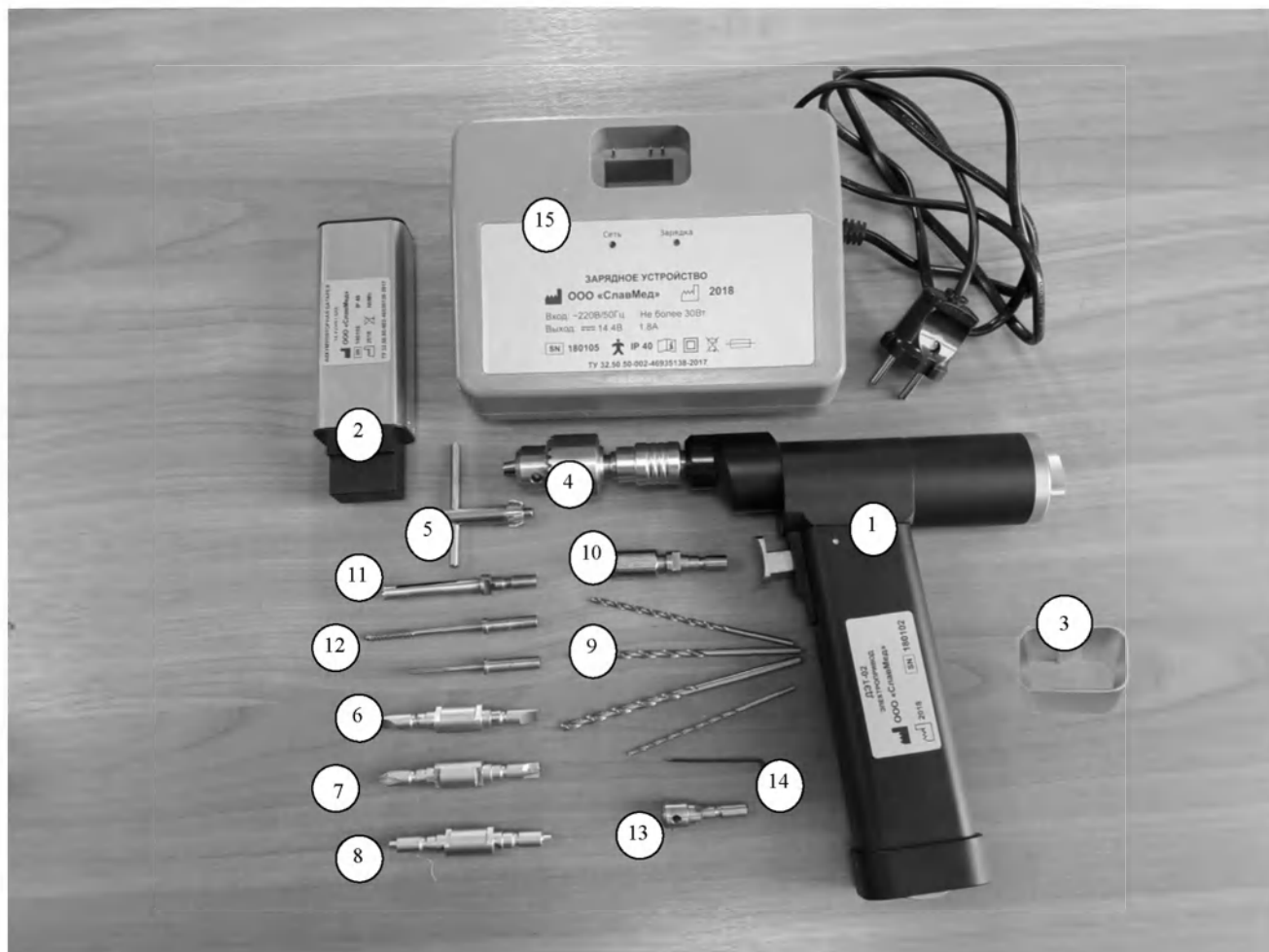
Рис.1 Электродрель ДЭТ-02. 1-электропривод с быстросъемным патроном, 2-аккумуляторная батарея 14,4В, 3-асептический переходник, 4- патрон универсальный, 5-ключ к универсальному патрону, 6-отвертка плоская, 7-отвертка крестовая, 8-отвертка шестигранная, 9-набор сверл, 10-патрон для спиц, 11- фреза полая, 12- набор метчиков для кортикальной резьбы, 13-адаптер для сверла, 14-отвертка технологическая, 15-зарядное устройство 220/14,4В.
