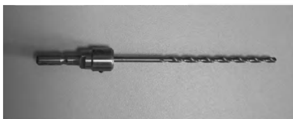
Рис.23. Установка сверла в адаптере
