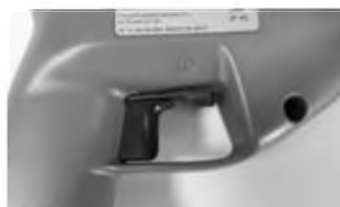
Рис. 20 Кнопка включения движения и переключатель реверса.
