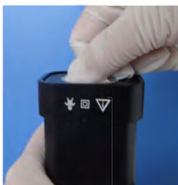
Рис.8 Снятие фиксации крышки рукоятки Рис.9 Установка батареи внутри рукоятки
