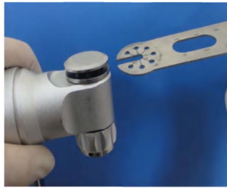
Рис.38 Установка полотна секторного
