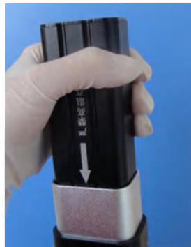
Рис.16 Вставка батареи внутрь рукоятки
