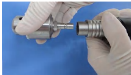
Рис. 22. Установка универсального патрона
