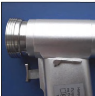
Рис. 30 Рычаг для извлечения аккумуляторной батареи из разъема
