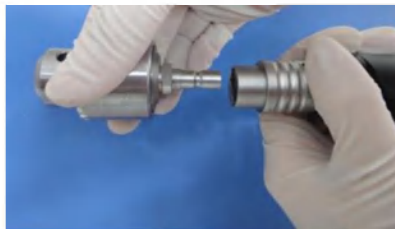
Рис. 23. Установка универсального патрона
