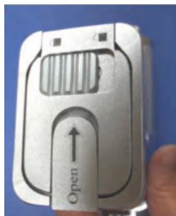
Рис. 17. Снятие блокировки и фиксации крышки рукоятки корпуса
