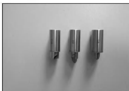
Рис.8. Набор насадок для краниотомии (d=6,0 мм; 9,0 мм; 12,0 мм)
