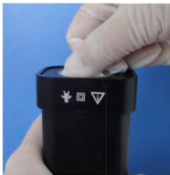
Рис. 16 Снятие фиксации крышки рукоятки
