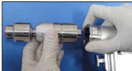
Рис. 31. Установка насадки дрель для сверления кости в разъем электропривода
