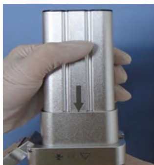
Рис. 29. Вставка аккумуляторной батареи внутрь рукоятки корпуса электропривода.
