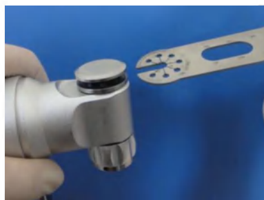
Рис.12. Установка полотна пилы
