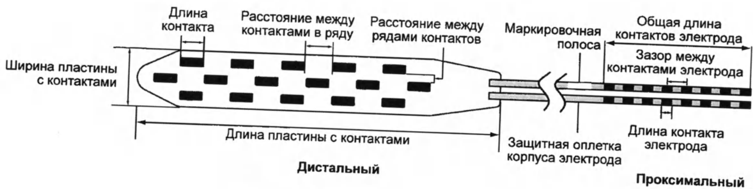
Рис. 1. Хирургический электрод Specific SureScan MRI 5-6-5 моделей 977C165 и 977C190 (показана сторона с контактами).
