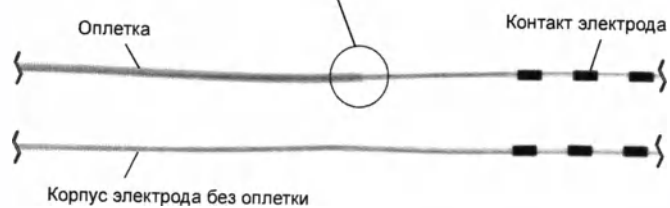
Рис. 2. Сравнение электрода Vectris SureScan MRI (с оплеткой) с электродом без оплетки.
