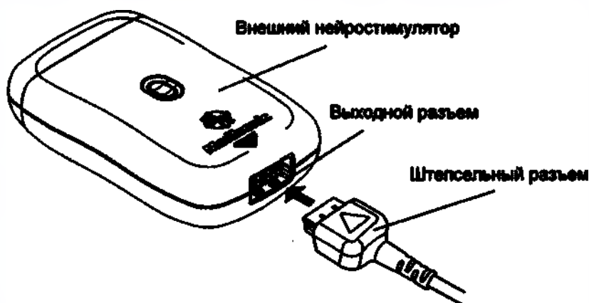
Рис. 5. Подсоединение многоэлектродного пробного кабеля к внешнему нейростимулятору.
