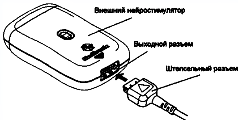
Рис. 3. Подсоединение многоэлектродного пробного кабеля к внешнему нейростимулятору.
