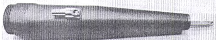
Рисунок 1.3.13 – Насадка для непрерывного режима ( f = 100 мм).
