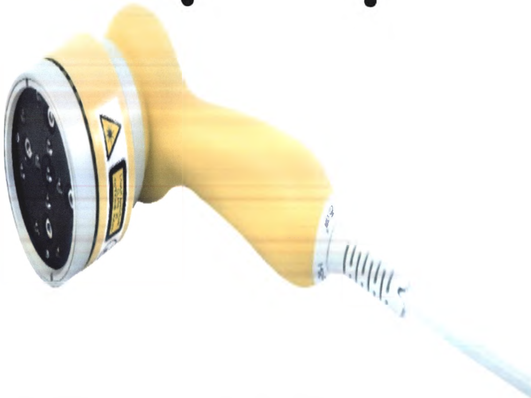
80. Кластер лазерный, комбинированный, 685 нм, 4 × 50 мВт; 830 нм, 4 × 200 мВт (не более 4 шт.).
