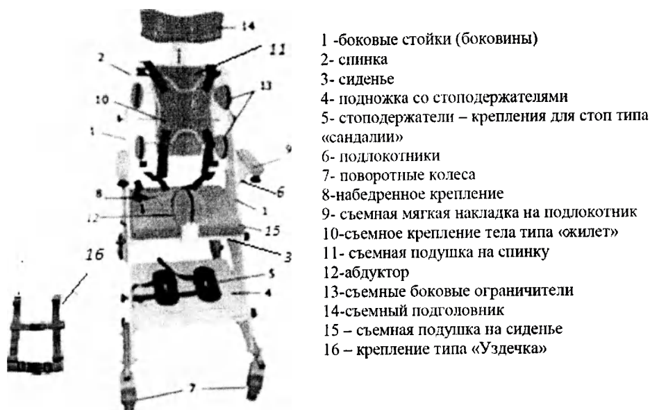
Рис.1-опора функциональная для сидения для детей инвалидов «Я МОГУ», исполнение ОС-005. Принадлежности: съемный подголовник «мягкий», съемное крепление тела типа «жилет», съемная подушка на спинку, съемные боковые ограничители, съемная мягкая накладка на подлокотник
