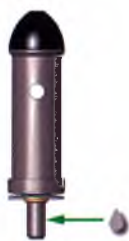
Рис. III-4: Нанесение смазки на резьбовой участок крепежного винта ротора
