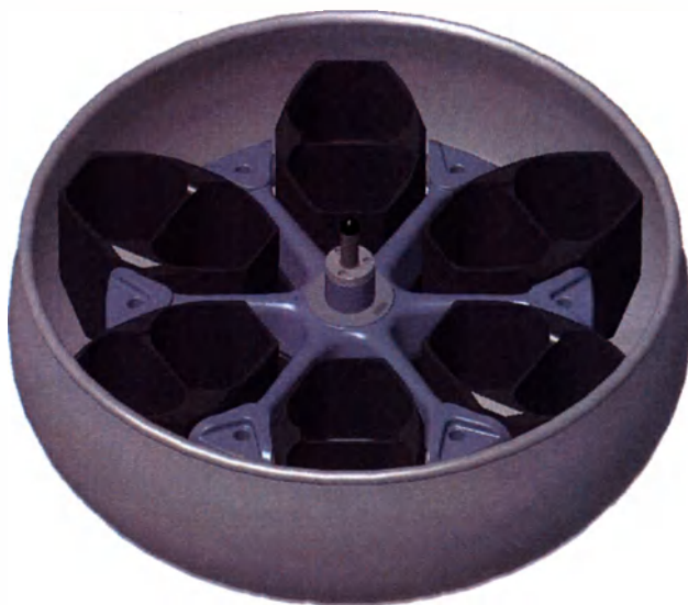
Рис. III-8: Установка стаканов в ротор на примере HAEMAFlex 12
