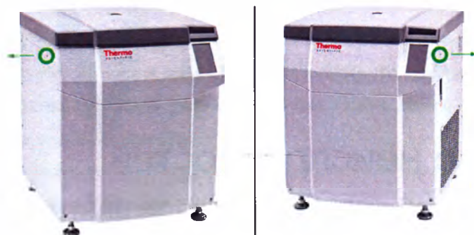
Рис. V-2: Расположение аварийной разблокировки
