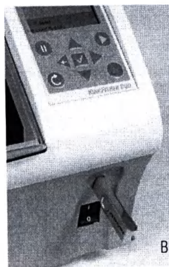
Рисунок 4-22. Запоминающее USB-устройство не подсоединено и подсоединено к KingFisher Duo
