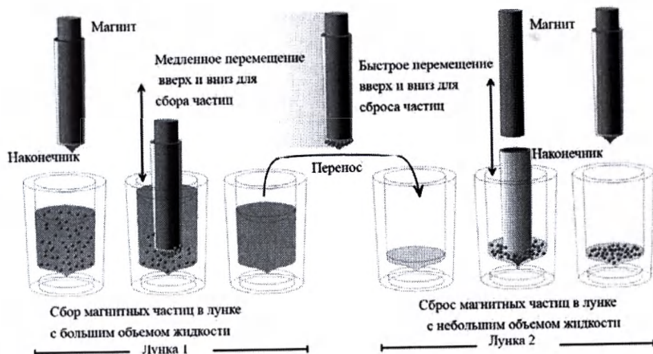
Рисунок 2-8. Этап концентрирования при обработке магнитных частиц
