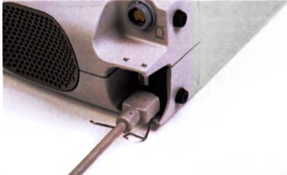
Рисунок 3.13 Подключение кабель питания к модулю питания
