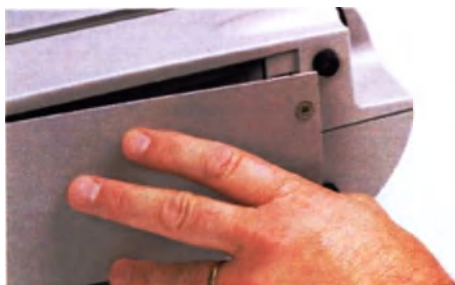
Рис. 3.29 Снимите крышку аккумуляторного отсека
