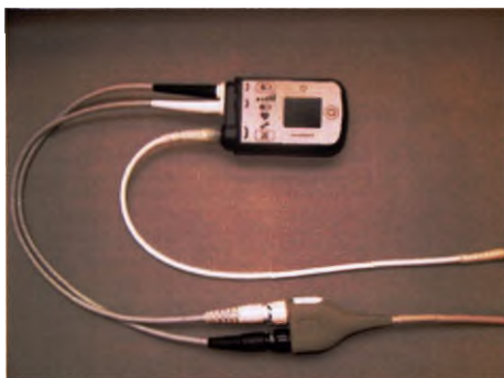
Рис. 4.20 Кабели питания и несущая линия не перекручены
