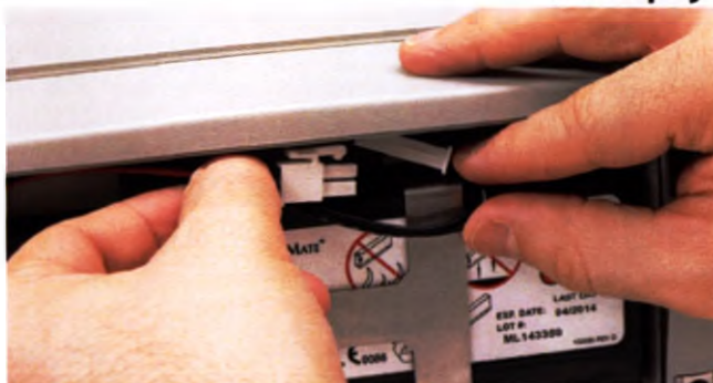
Рис. 45 Осторожно сложите провода и разъем по верху аккумулятора.
