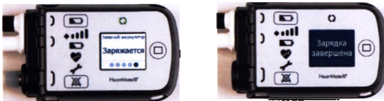
Рис. 2.26 Надпись «Заряжается» или «Зарядка завершена» на экране системного контроллера
