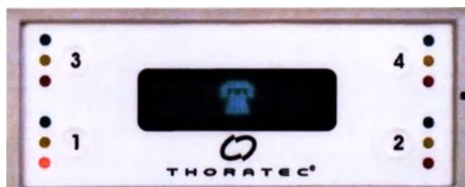
Рис. 7.5 Отображение информирующего сигнала в графическом режиме. Обратите внимание на красный светоиндикатор гнезда 1.
