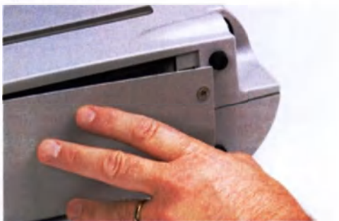
Рисунок 3.6 Снятие крышки аккумуляторного отсека
