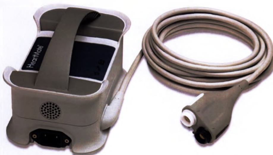
Рисунок 3.50 Кабель пациента к Mobile Power Unit
