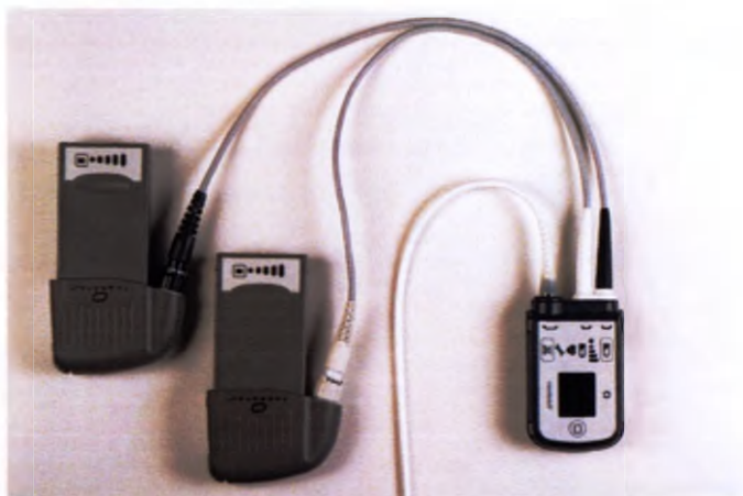
Рис. 3.25 Системный контроллер, подключенный к аккумуляторам
