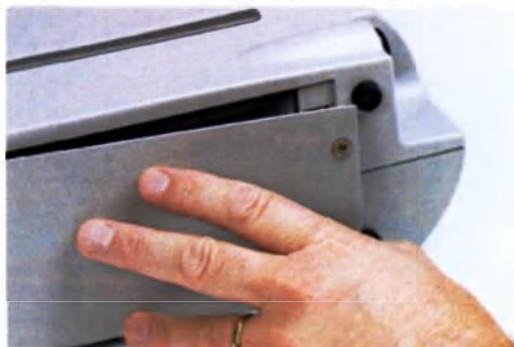
Рис. 42 Снимите крышку отделения аккумуляторов.
