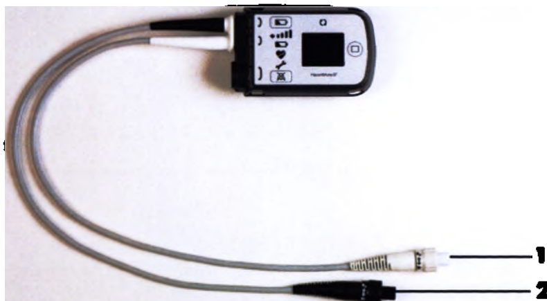
Рис. 3.9 Разъемы кабеля питания системного контроллера
