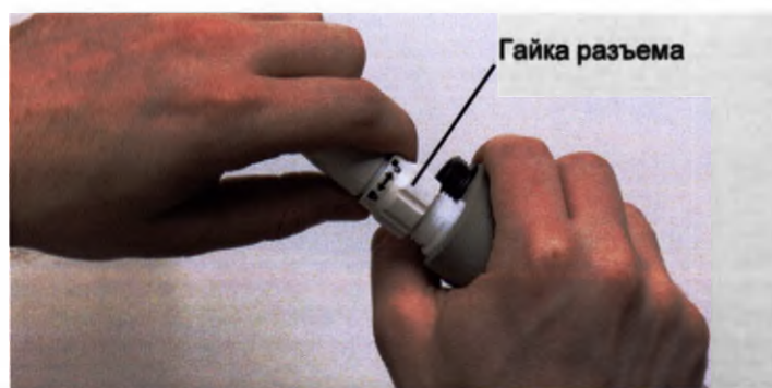
Рис. 7.7 Вращайте гайку на разъеме
