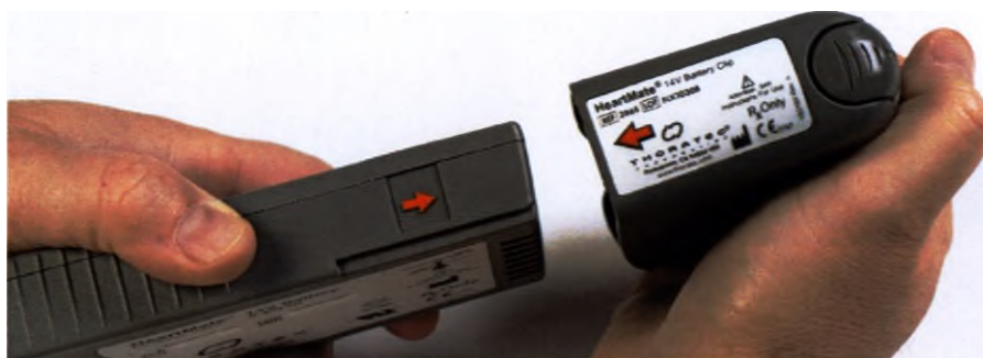
Рис. 3.22 Вставьте аккумулятор в аккумуляторный зажим
