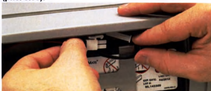
Рисунок 3.39 Осторожно вытащите провода и штепсели
