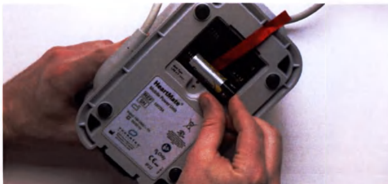
Рис. 3.43 Установите батареи типа AA
