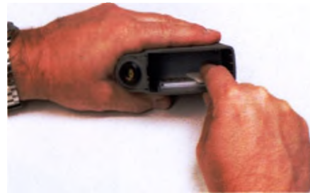
Рис. 6.1 Очистка контактов аккумуляторов и аккумуляторных зажимов
