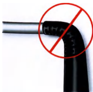
Рисунок 6.1 Не перегибайте кабели питания системного контроллера
