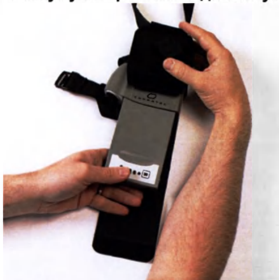
Рис. 143 Вставьте аккумулятор и зажим для аккумулятора в кобуру
