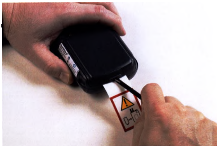
Рисунок 5.41 Снятие крышки с резьбой с помощью рычага
