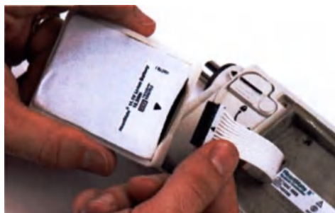
Рис. 5.29 Совместите стрелку на кабеле со стрелкой на аккумуляторе
