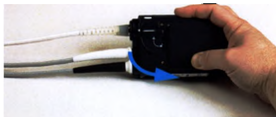
Рисунок 2.43 Снятие блокировки с предохранителя
