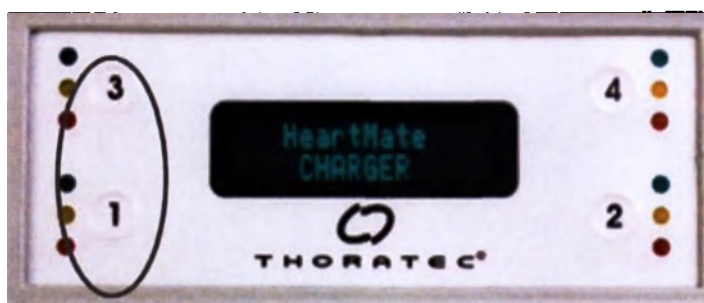
Рисунок 3.75 Нажмите и удерживайте кнопки 1 и 3, чтобы изменить режим отображения
