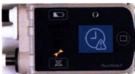
Рис. 2.31 Информировующий сигнал о не установленном времени в системном контроллере
