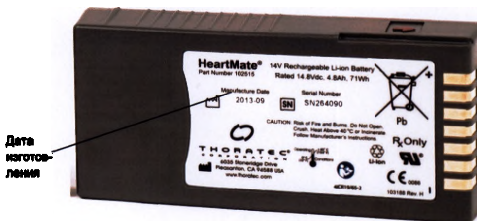
Рис. F.1 Проверьте срок годности по дате изготовления аккумулятора.
