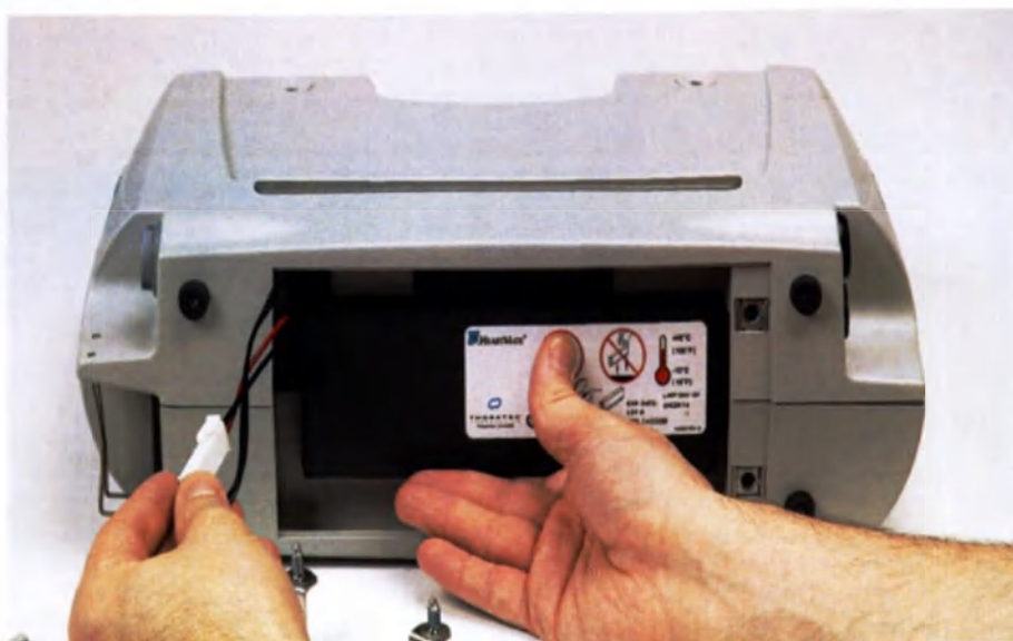
Рисунок 3.9 Размещение аккумулятора в аккумуляторном отсеке
