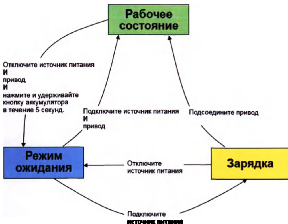
Рисунок 2.22 Режимы работы системного контроллера
