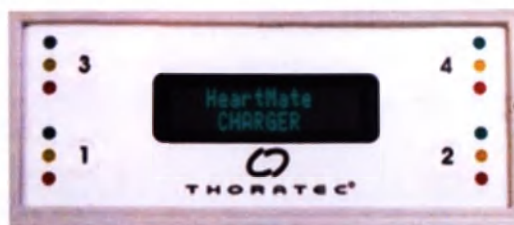
Рис. 3.75 Световые индикаторы заряда (зеленый, желтый, красный) для гнезд 1–4
