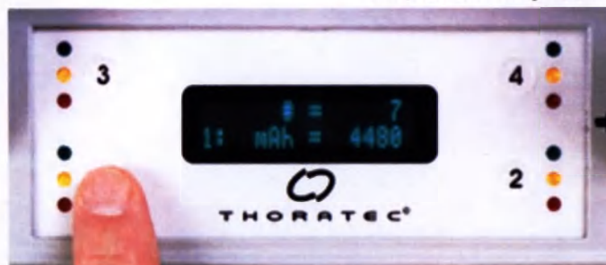
Рис. 83 Нажмите кнопку второй раз, чтобы отобразить сведения о циклах заряда аккумулятора
