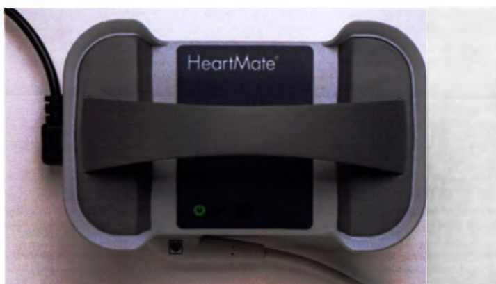
Рис. 3.46 Портативный блок питания готов к использованию
