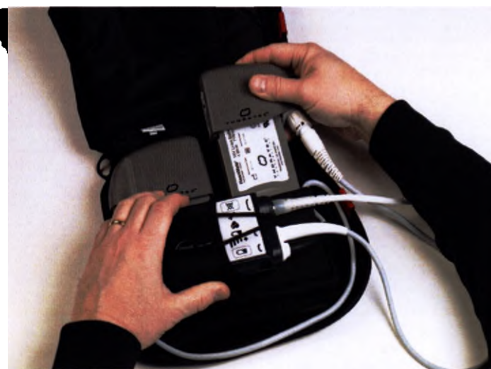
Рисунок 6.38 Размещение второго аккумулятора в сумке
