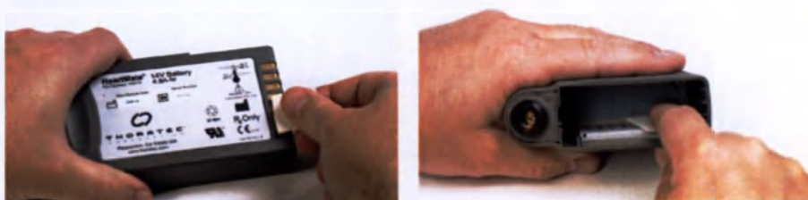
Рисунок 8.1 Очистка контактов аккумуляторов и зажимов
