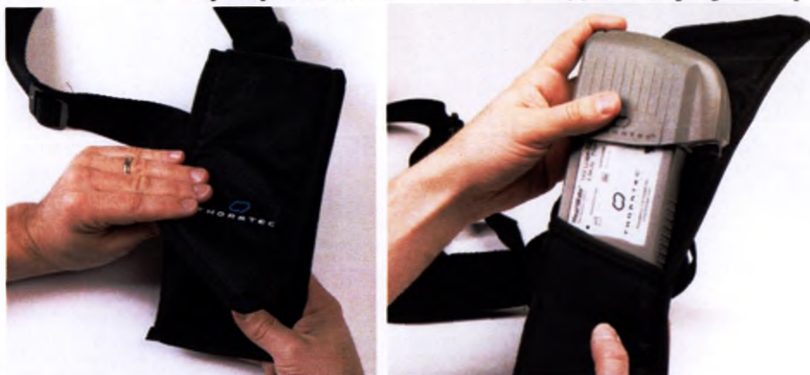
Рис. 137 Расстегните липучку VELCRO и вставьте аккумулятор с прикрепленным зажимом для аккумулятора
