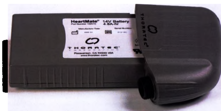
Рис. 55 Ионно-литиевый аккумулятор HeartMate на 14 В и зажим для аккумулятора на 14 В
