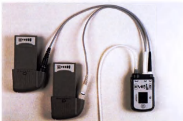
Рис. 4.8 Кабели питания и несущая линия не перекручены
