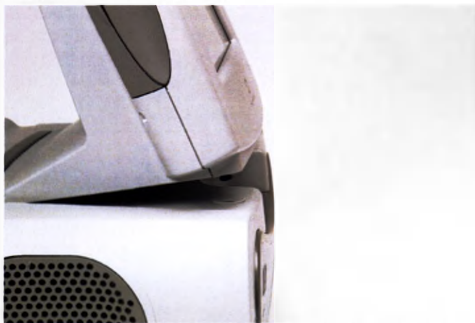
Рисунок 4.6 Фиксация ножек системного монитора во втулках модуля питания
