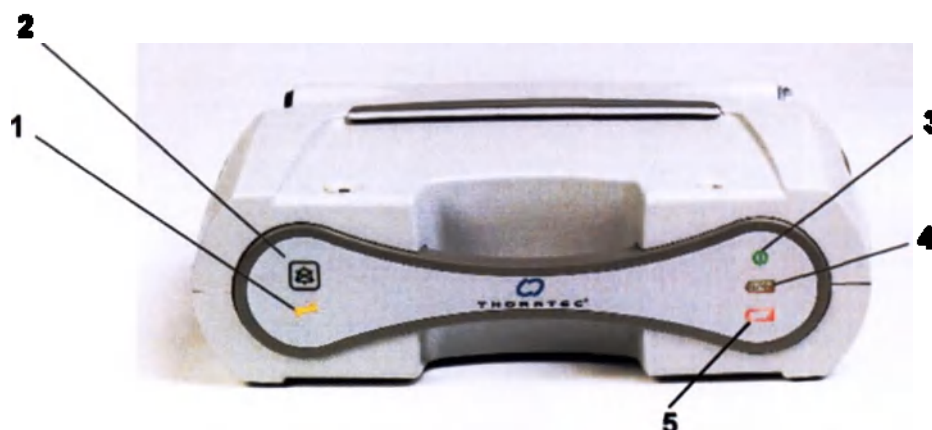
Рисунок 7.4 Индикаторы сигнала тревоги на передней панели модуля питания
