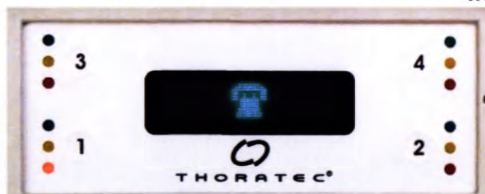
Рис. 150 Символ телефона и красный индикатор зарядного гнезда 1 указывают на то, что зарядное устройство обнаружило неисправность
