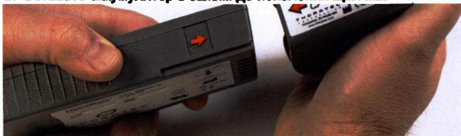
Рис. 3.28 Вставка аккумулятора в аккумуляторный зажим
