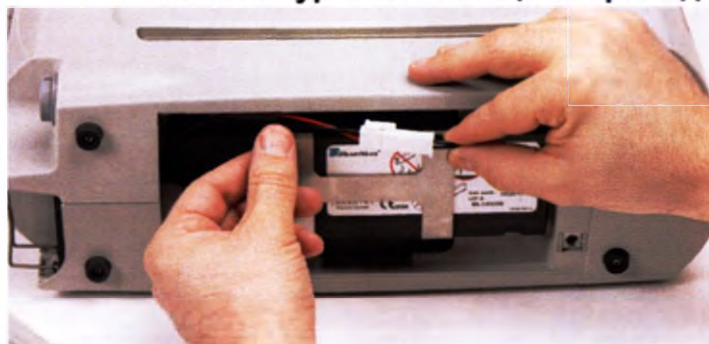
Рис. 43 Аккуратно вытащите провода и разъемы.
