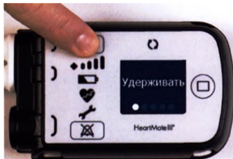
Рисунок 2.34 Нажатие и удерживание кнопки аккумулятора
