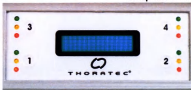
Рис. 76 При включении зарядного устройства на передней панели загораются все индикаторы
