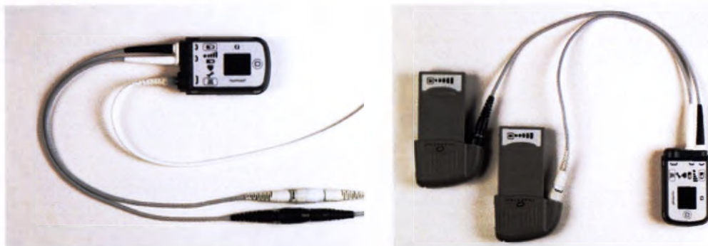
Рис. 2.25 Системный контроллер, подключенный к Mobile Power Unit (слева) и к аккумуляторам (справа)
