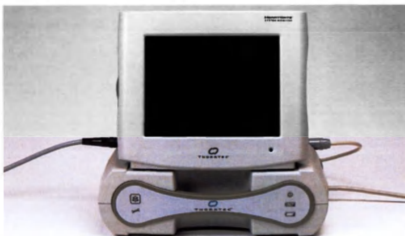
Рис. 4.1 Системный монитор, установленный на модуле питания
