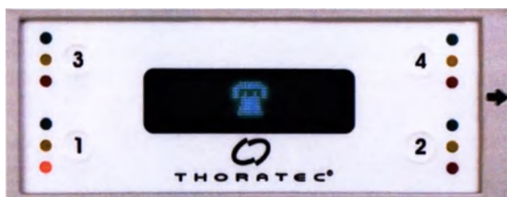
Рис. 5.5 Символ телефона и индикатор красного цвета возле гнезда 1 указывают на то, что зарядное устройство обнаружило неисправность
