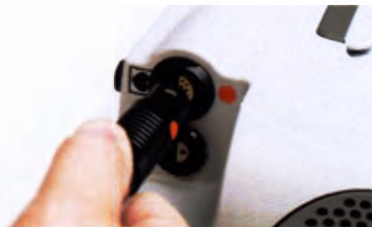
Рис. 3.19 Совместите красную точку на разъеме с красной точкой на модуле питания
