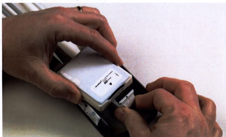
Рисунок 2.33 Установка резервного аккумулятора
