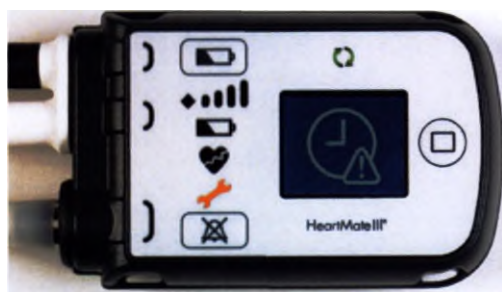
Рисунок 2.29 Информирование о неустановленном времени на системном контроллере
