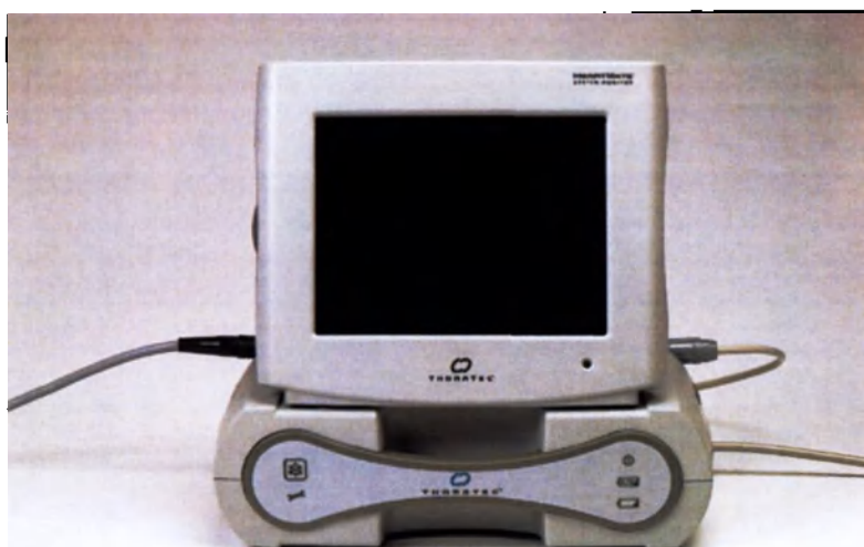
Рис. 4.4 Системный монитор, установленный на модуле питания
