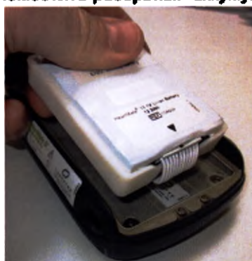
Рисунок 5.44 Аккумулятор, помещенный в аккумуляторный отсек
