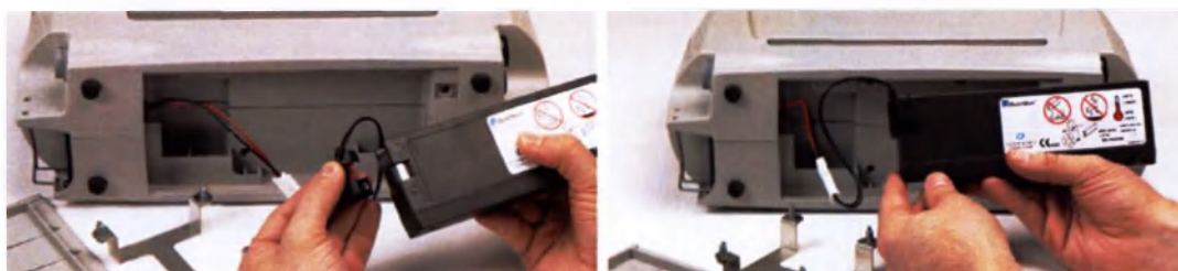
Рис. 3.5 Прикрепите аккумулятор к разъему аккумулятора
