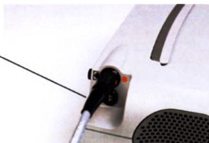
Рисунок 3.69 Потяните за черный компенсатор натяжения, чтобы проверить соединение
