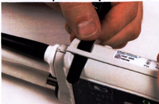
Рис. 110 Протяните ремень через точку крепления
