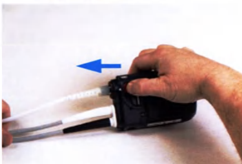
Рис. 2.13 Отключение несущей линии
