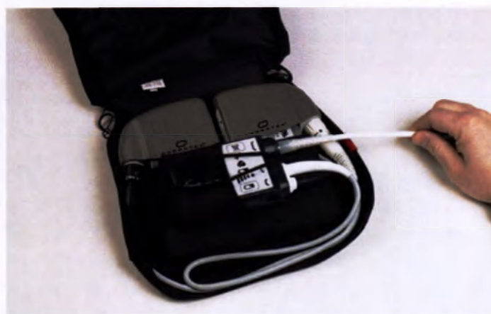
Рисунок 6.40 Закрытие сумки: Привод выходит через красные защитные язычки
