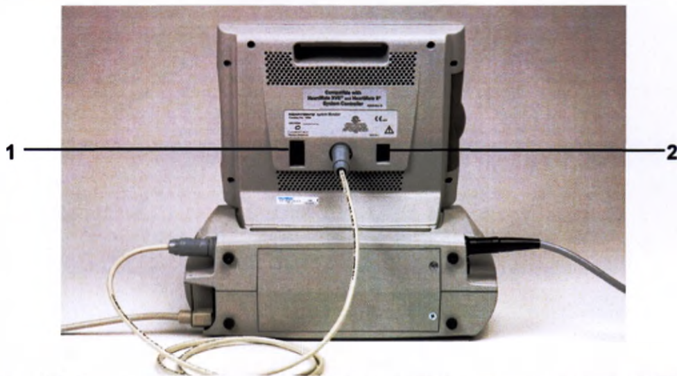
Рисунок 4.2 Подключение кабеля передачи данных системного монитора к модулю питания
