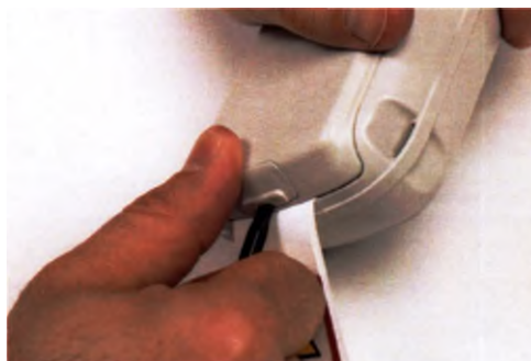
Рис. 5.27 Используйте рычаг для снятия крышки для скрытия винтов
