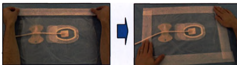
Рисунок 6.3 Использование пластыря для герметизации краев универсальной герметичной оболочки
