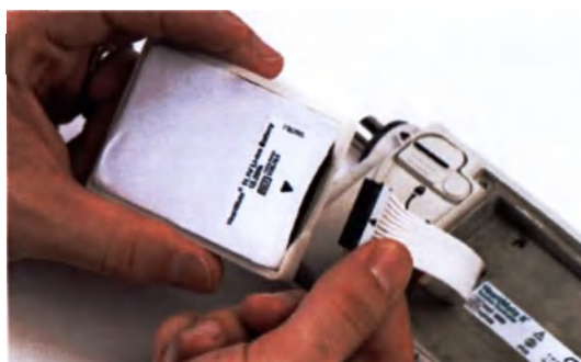
Рис. 2.28 Извлеките шлейф из гнезда аккумулятора
