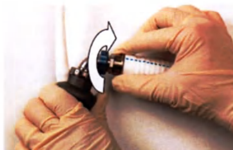
Рис. 5.21 Вращайте соединение компенсатора изгиба, чтобы проверить соединение
