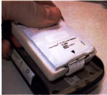
Рисунок 2.27 Извлечение ленточного кабеля из гнезда аккумулятора
