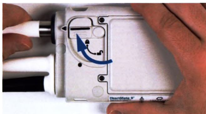
Рис. 2.12 Вставьте несущую линию в гнездо
