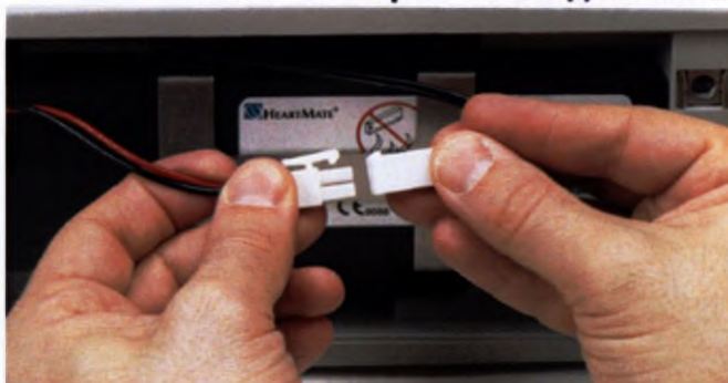
Рис. 50 Выровняйте две половины разъема
