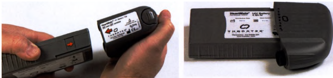
Рис. 3.27 Совместите стрелки оранжевого цвета и вставьте аккумулятор в аккумуляторный захват
