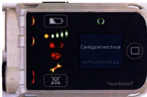
Рис. 2.17 Пользовательский интерфейс во время самодиагностики системного контроллера
