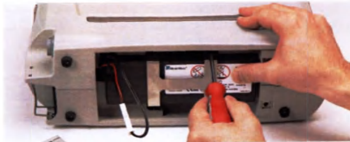
Рис. 3.7 Установите металлическую скобу на место
