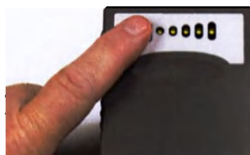
Рисунок 3.61 Индикатор заряда на аккумуляторе и нажатие символа в виде аккумулятора для активации полос
