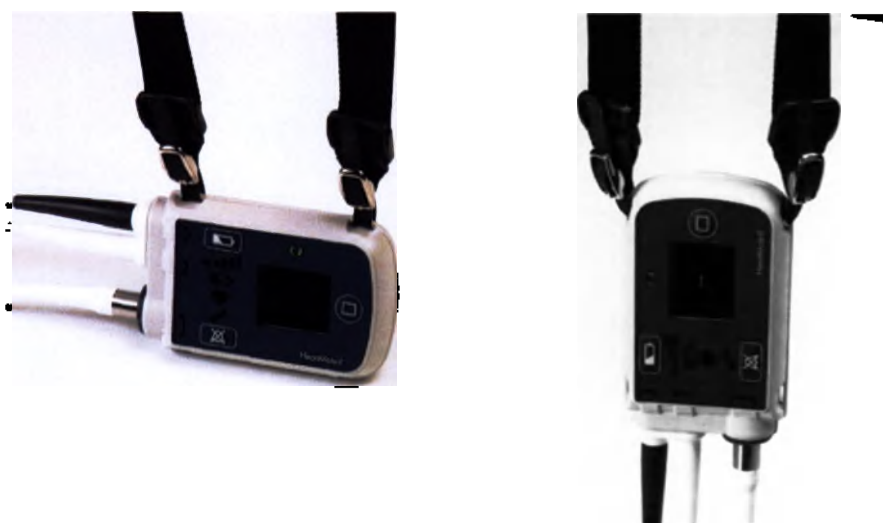
Рис. 6.22 Системный контроллер, подвешенный на шейном ремне в горизонтальном (слева) и вертикальном (справа) положении
