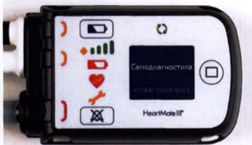
Рисунок 2.17 Пользовательский интерфейс во время самодиагностики системного контроллера
