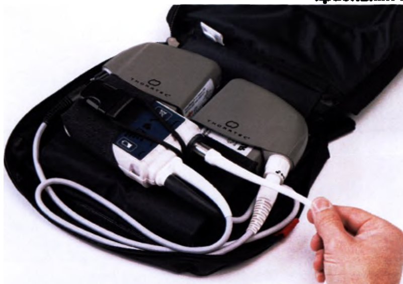
Рис. 129 Закройте сумку так, чтобы несущая линия выходила между красными язычками
