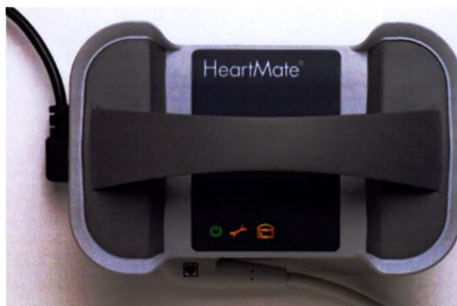
Рис. 7.4 Индикаторы на портативном блоке питания
