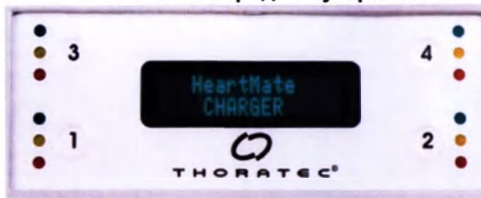
Рис. 77 Зарядное устройство готово к работе
