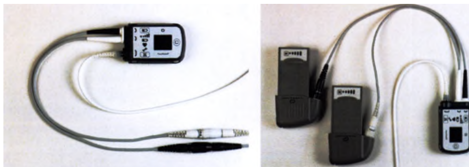
Рисунок 2.35 Системный контроллер с питанием от модуля питания (слева) и аккумуляторов (справа)
