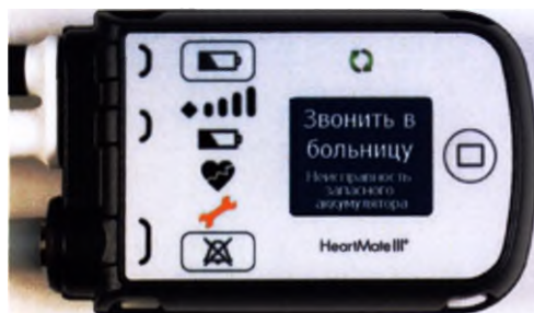
Рисунок 2.23 Сигнал тревоги Backup Battery Fault (Неисправность запасного аккумулятора)
