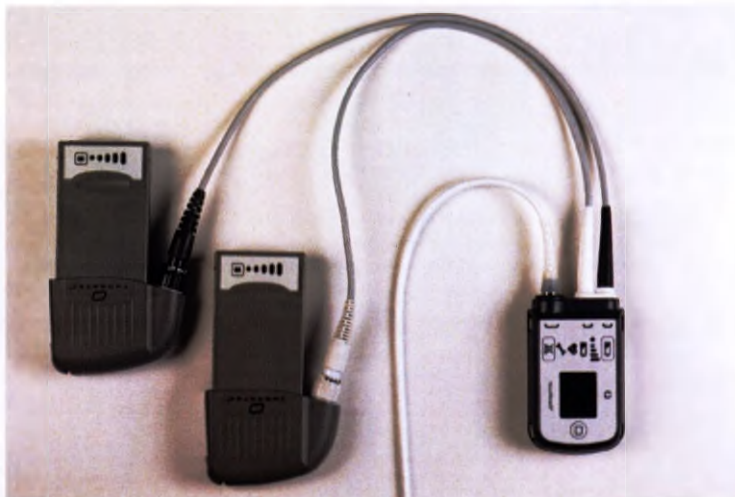
Рисунок 3.64 Кабели питания системного контроллера, подключенные к аккумуляторным зажимам
