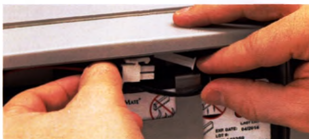
Рис. 3.32 Осторожно заправьте провода и разъем над верхней поверхностью аккумулятора
