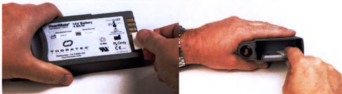
Рис. 153 Чистка контактов аккумуляторов и зажимов
