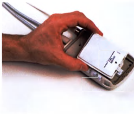
Рис. 2.29 Поместите аккумулятор в аккумуляторный отсек
