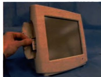
Рис. 4.33 Карта данных (слева) и вставка карты данных в системный монитор (справа)
