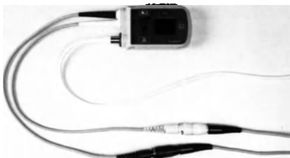
Рис. 3.23 Кабели питания системного контроллера, подключенные к кабелям пациента к модулю питания
