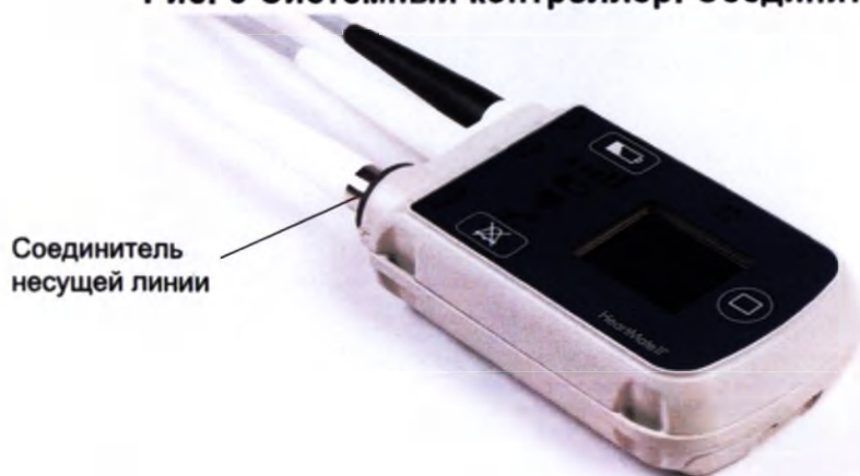
Рис. 6 Системный контроллер. Соединитель несущей линии
