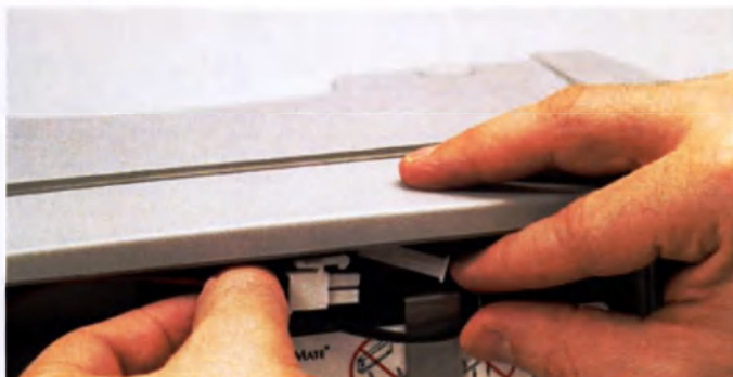
Рисунок 3.35 Провода и разъем, аккуратно сложенные на поверхности аккумулятора
