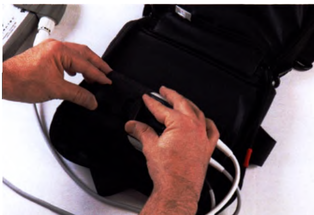
Рис. 6.38 Натяните ремень поверх системного контроллера и между кабелями
