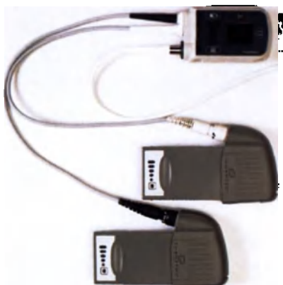
Рис. 3.61 Кабели питания системного контроллера, подключенные к аккумуляторным обоймам
