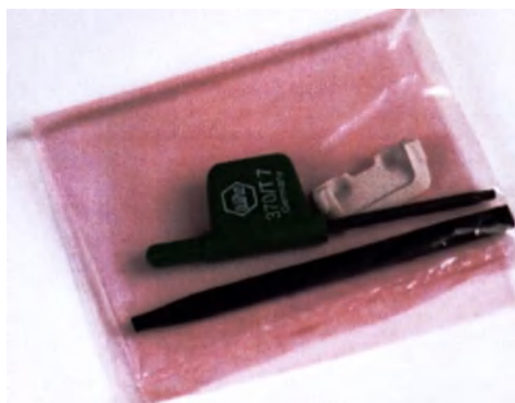
Рисунок 2.24 Комплект для замены резервного аккумулятора на 11 В
