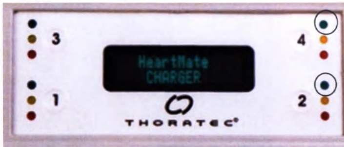
Рис. 3.32 Свечение зеленого цвета указывает на заряженный аккумулятор
