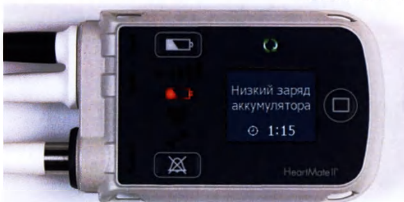
Рис. 19 Сигнал о низком заряде аккумулятора (питания осталось менее чем на 5 минут)
