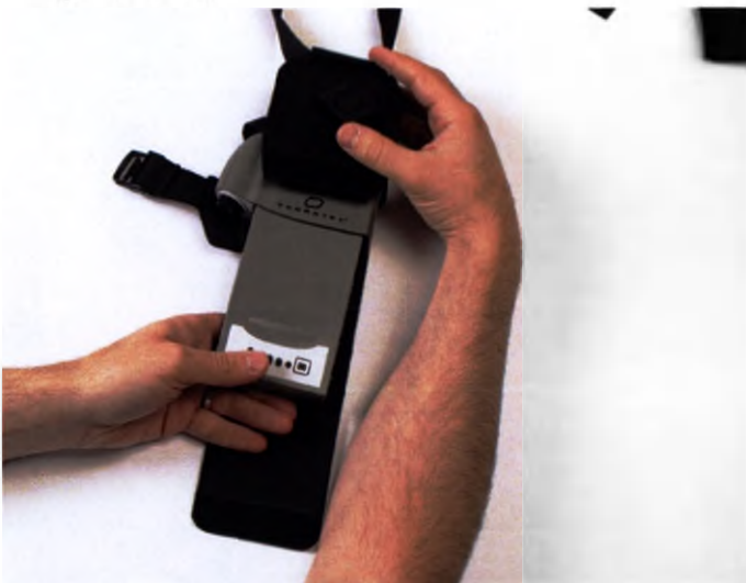
Рис. 4.55 Вставка аккумулятора и аккумуляторной обоймы в кобуру
