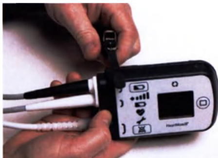
Рис. 4.21 Протягивание ремня через точку крепления
