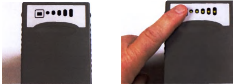
Рис. 3.21 Нажмите кнопку аккумулятора для проверки уровня заряда аккумулятора
