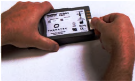
Рис. 6.1 Очистка контактов аккумуляторов и аккумуляторных зажимов
