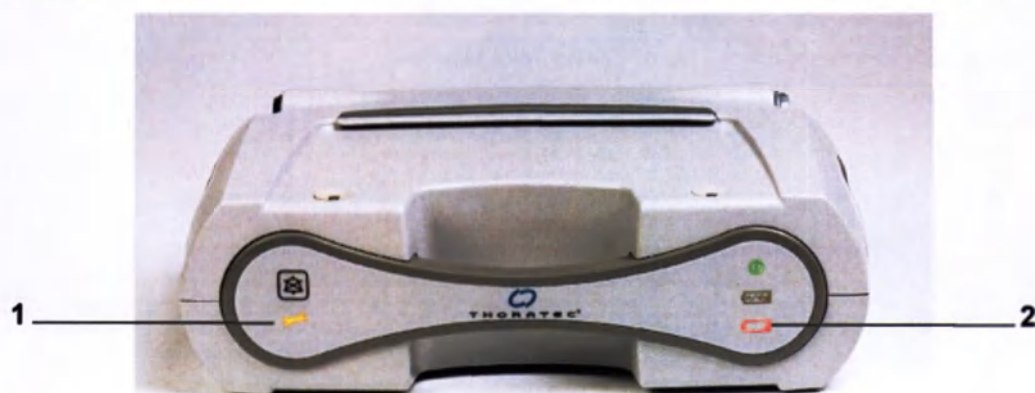
Рисунок 3.30 Желтый индикатор в виде гаечного ключа и красный индикатор опасности в виде аккумулятора (резервный аккумулятор модуля питания не работает)
