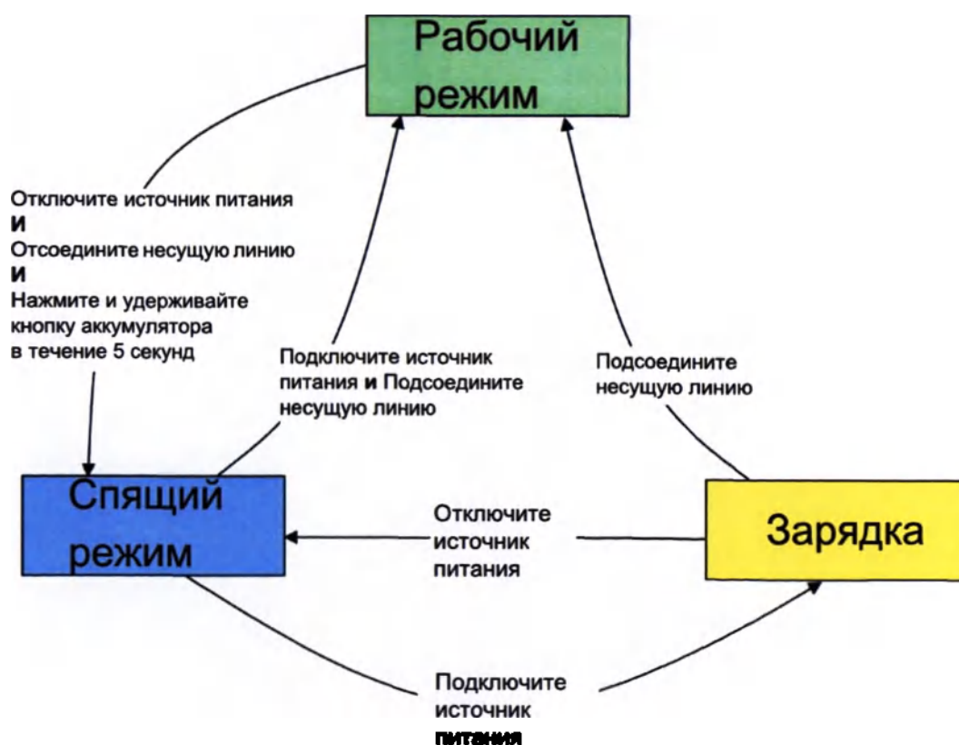
Рис. 23 Режимы работы системного контроллера
