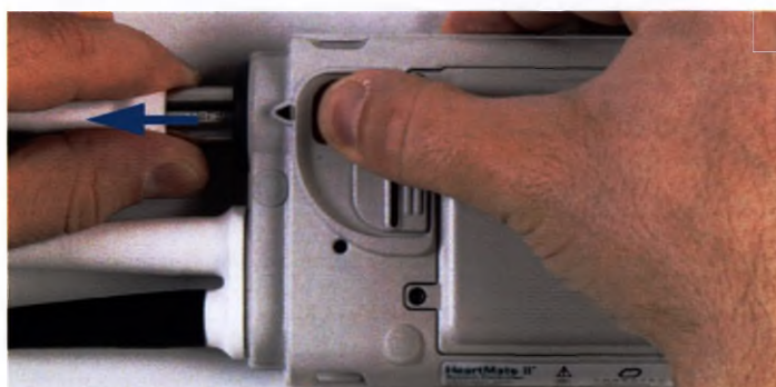
Рис. 12 Выньте несущую линию из разъема на системном контроллере
