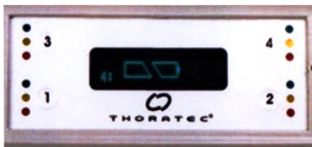
Рис. 3.41 Аккумулятор в 4-м гнезде во время калибровки
