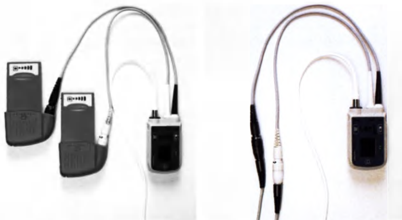
Рис. 2.19 Системный контроллер в режиме Рабочий на аккумуляторах (слева) и на модуле питания (справа)
