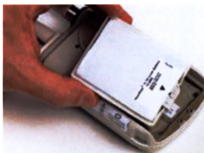
Рис. 5.30 Поместите аккумулятор в аккумуляторный отсек
