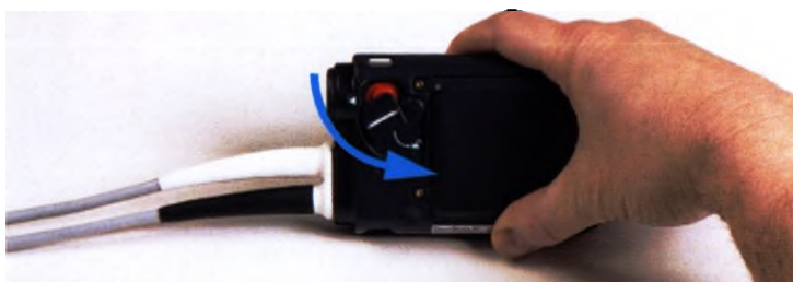
Рис. 2.9 Снятие блокировки с предохранителя
