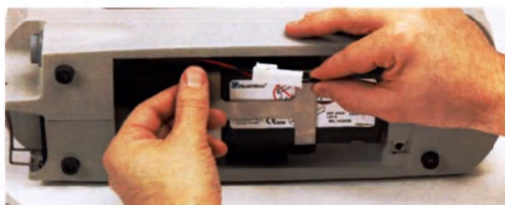
Рис. 3.38 Осторожно заправьте провода и разъем над верхней поверхностью аккумулятора
