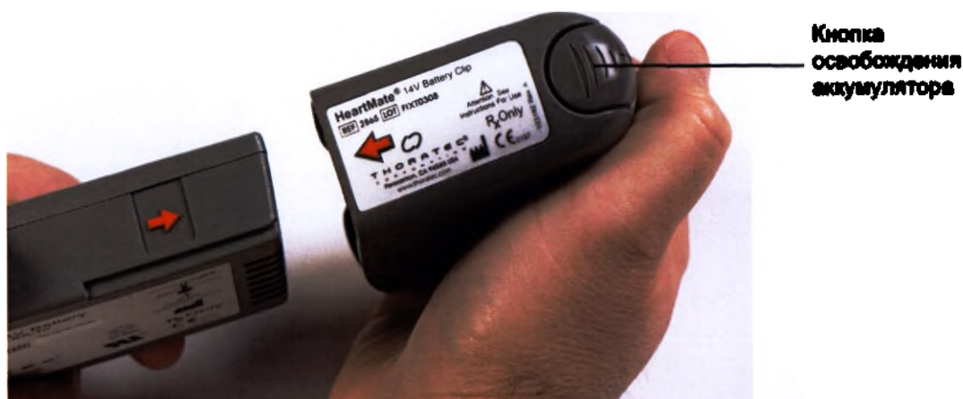
Рис. 3.20 Нажмите кнопку освобождения аккумулятора и извлеките его
