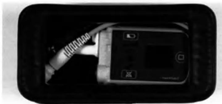
Рис. 6.57 Защитная сумка с запасным системным контроллером и кабелями питания внутри сумки
