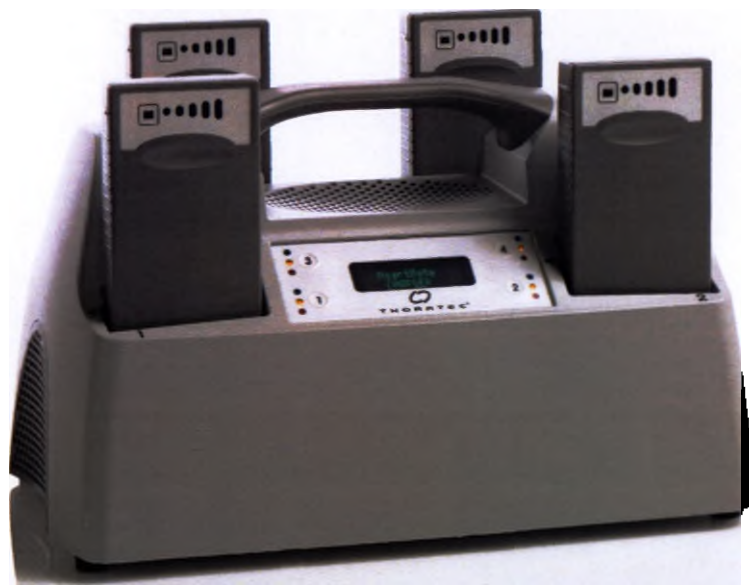
Рис. 3.31 Аккумуляторы, установленные в гнезда зарядного устройства для подзарядки
