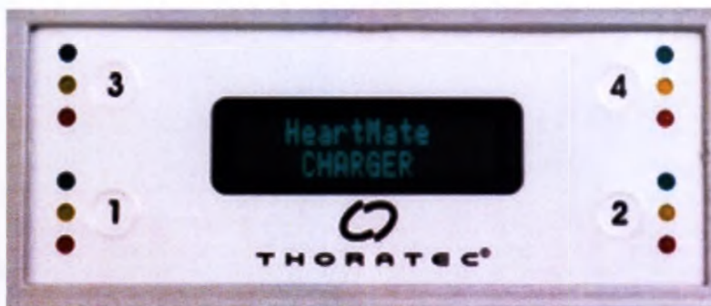
Рисунок 3.78 Световые индикаторы заряда (зеленый, желтый, красный) для гнезд 1–4
