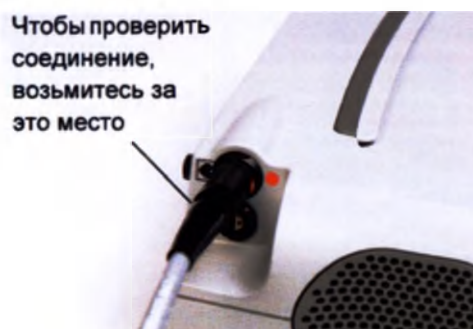
Рис. 3.66 Потяните за черный компенсатор натяжения, чтобы проверить соединение
