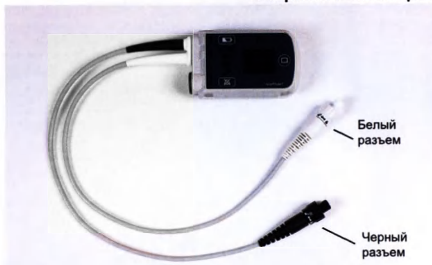
Рис. 61 Кабели электропитания системного контроллера с черным и белым разъемами
