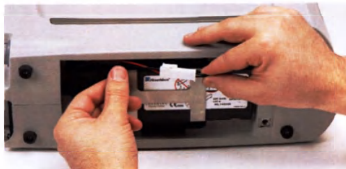
Рис. 3.8 Сложите провода и разъем по верху аккумулятора
