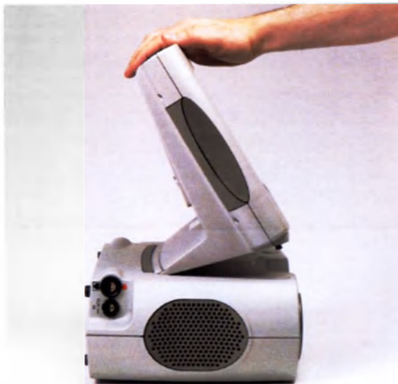
Рис. 4.5 Вставьте задний край основания системного монитора под край выступа на верхней части модуля питания.
