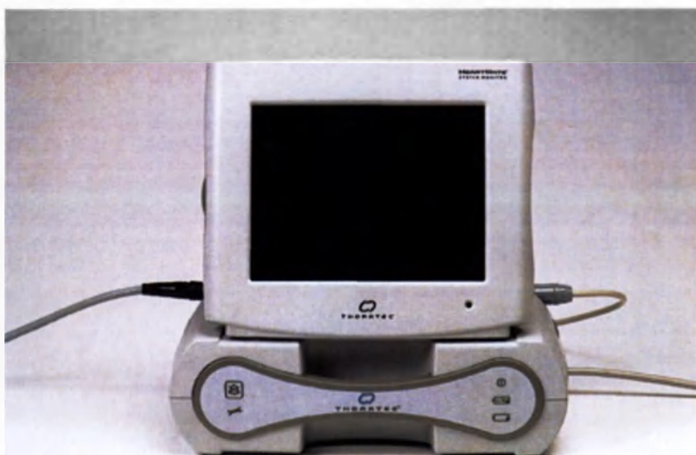
Рисунок 4.4 Системный монитор установлен на модуле питания
