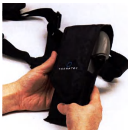
Рис. 6.49 Аккумулятор в кобуре с застегнутыми застёжками
