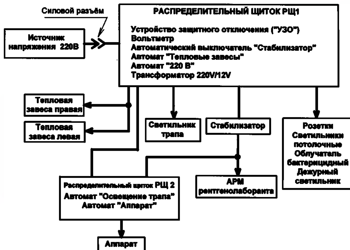
Рисунок В.1 – Схема электрическая соединений КФП-Ц
