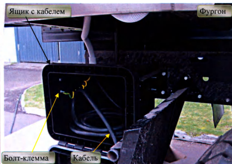
Рисунок 8 – Подключение кабеля силового
