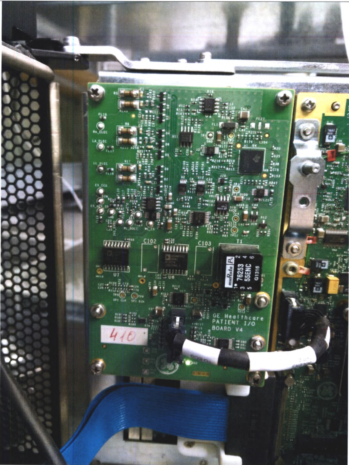
83. Модуль, обеспечивающий регистрацию физиологических сигналов в 3 отделениях, для взрослых (не более 2 шт.)
