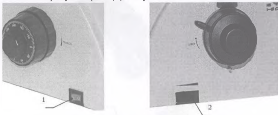
Рисунок 6. Включение и регулировка освещения. 1 – кнопка включения, 2- регулятор освещенности
