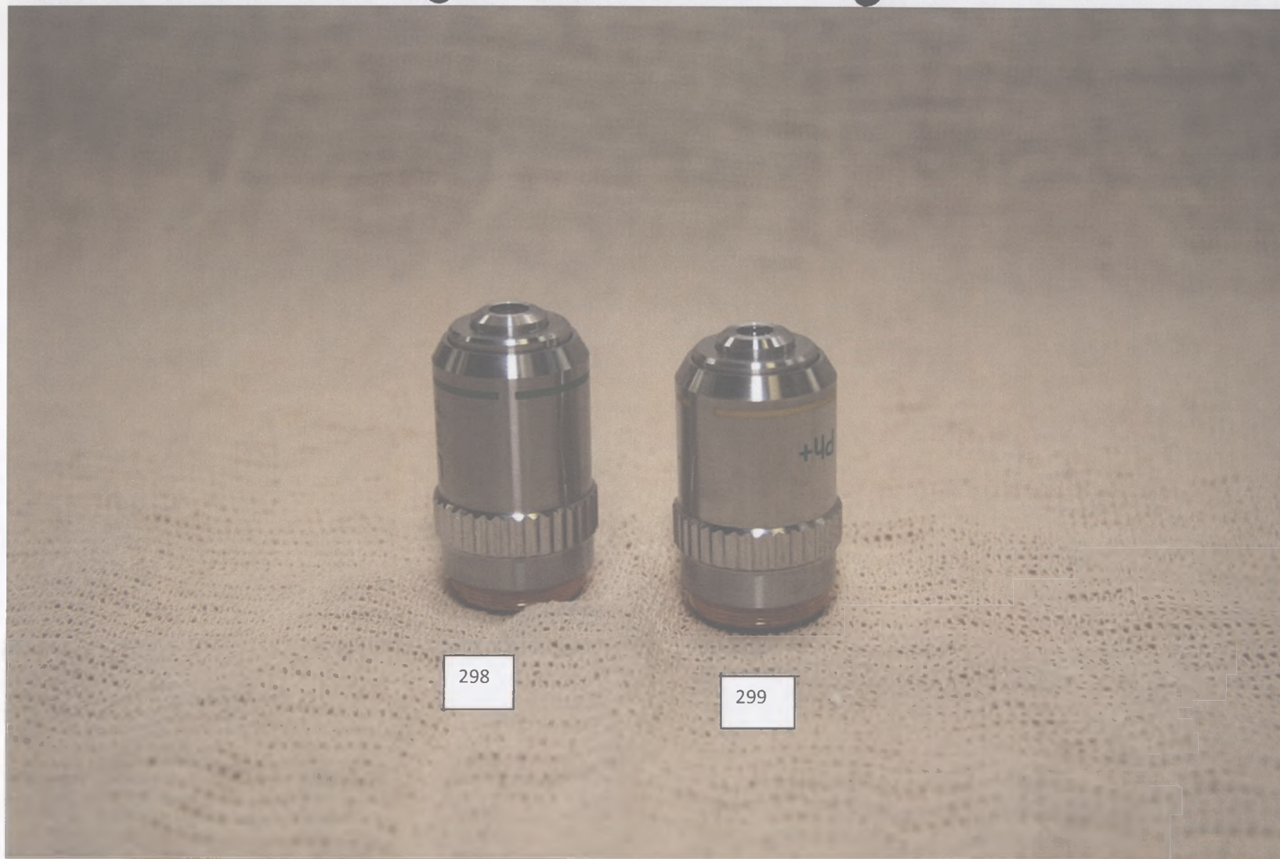
298. Объектив длиннофокусный фазово-контрастный LWD PH 4x 299. Объектив длиннофокусный фазово-контрастный LWD PH 10x
