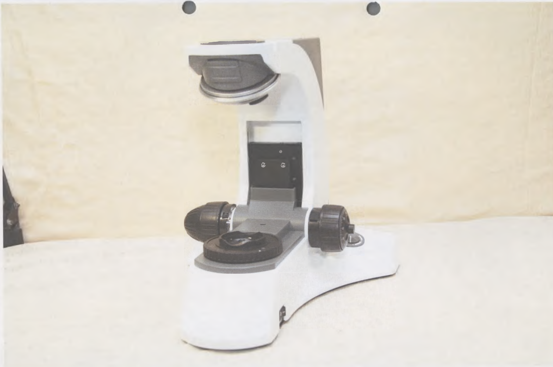
2. Штатив микроскопа БиОптик С-300 со светодиодным источником света
