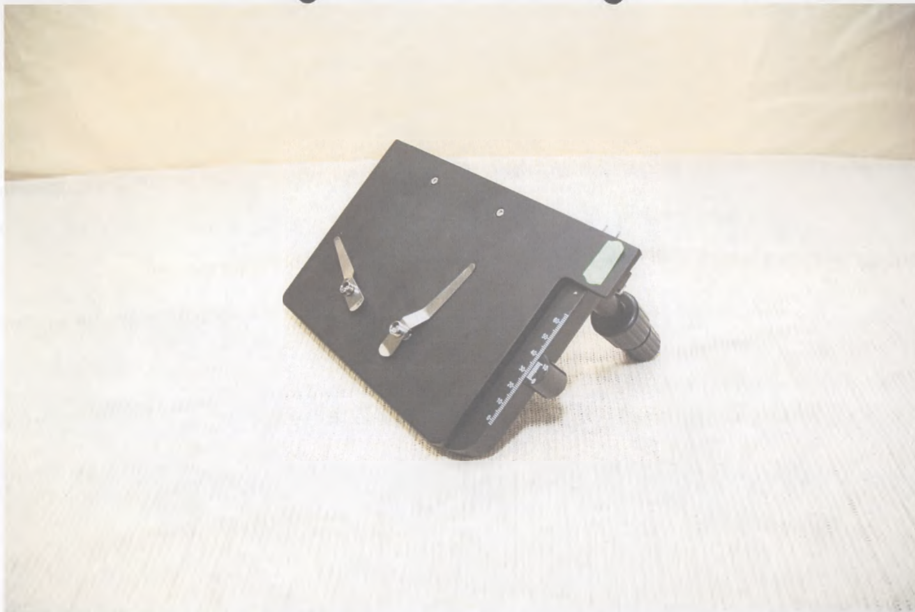
57. Предметный столик прямоугольный с координатным перемещением препарата размером 200x140 мм, диапазон перемещения препарата 76x52 мм
