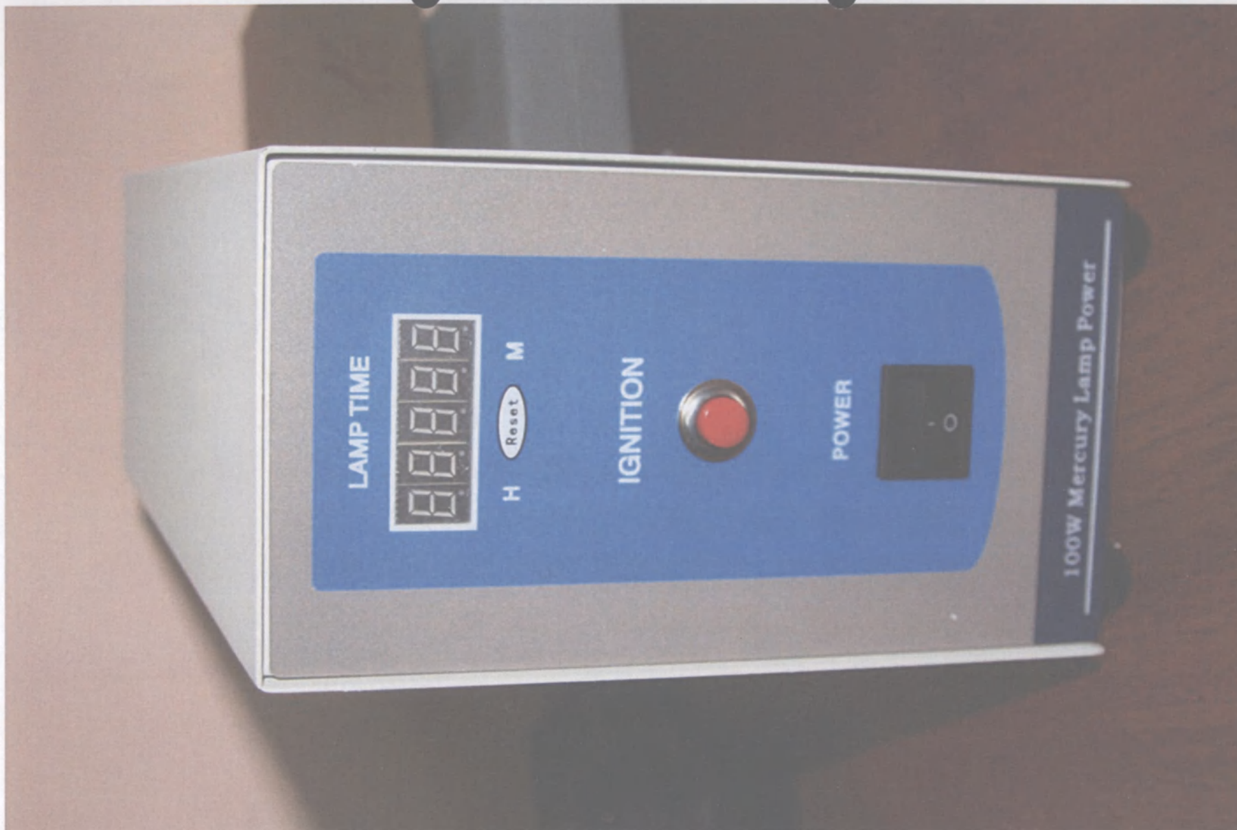
279. Внешний блок питания ртутной лампы для флуоресценции (100Вт, (100-240)В, (50/60) Гц)
