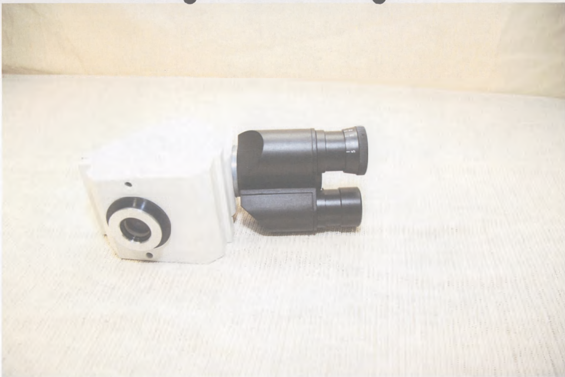
105. Тубус бинокулярный, угол наклона регулируемый в диапазоне от 5^{\circ} до 35^{\circ} , вращаемый на 360^{\circ} , межзрачковое расстояние 48-75 мм
