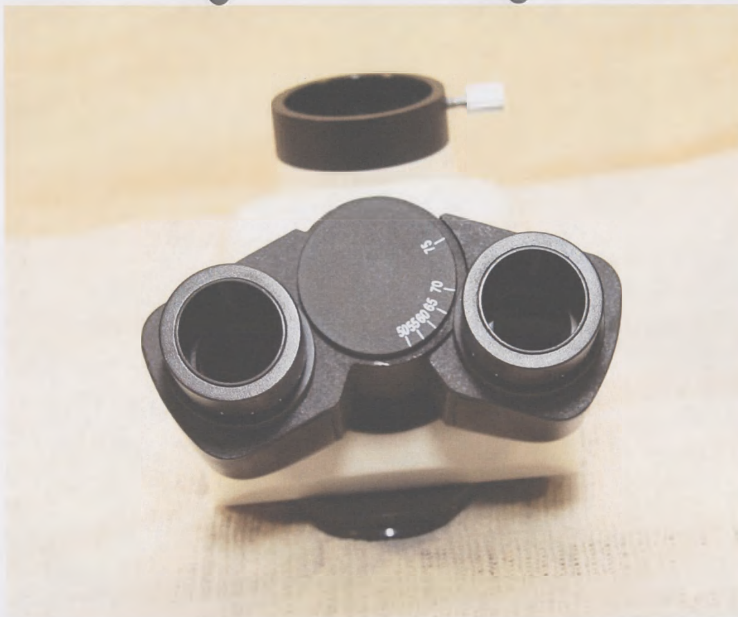
2. Тубус тринокулярный, угол наклона 30^\circ , вращаемый на 360^\circ , межзрачковое расстояние 50-75 мм
