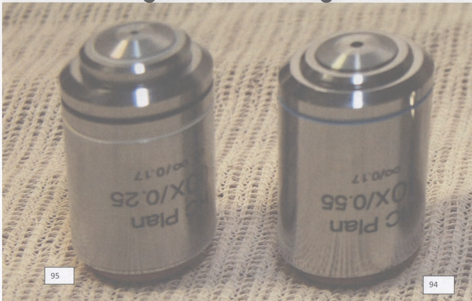
94. Объектив ICCF Infinity HC Plan Achromatic 20x 95. Объектив ICCF Infinity HC Plan Achromatic 60x
