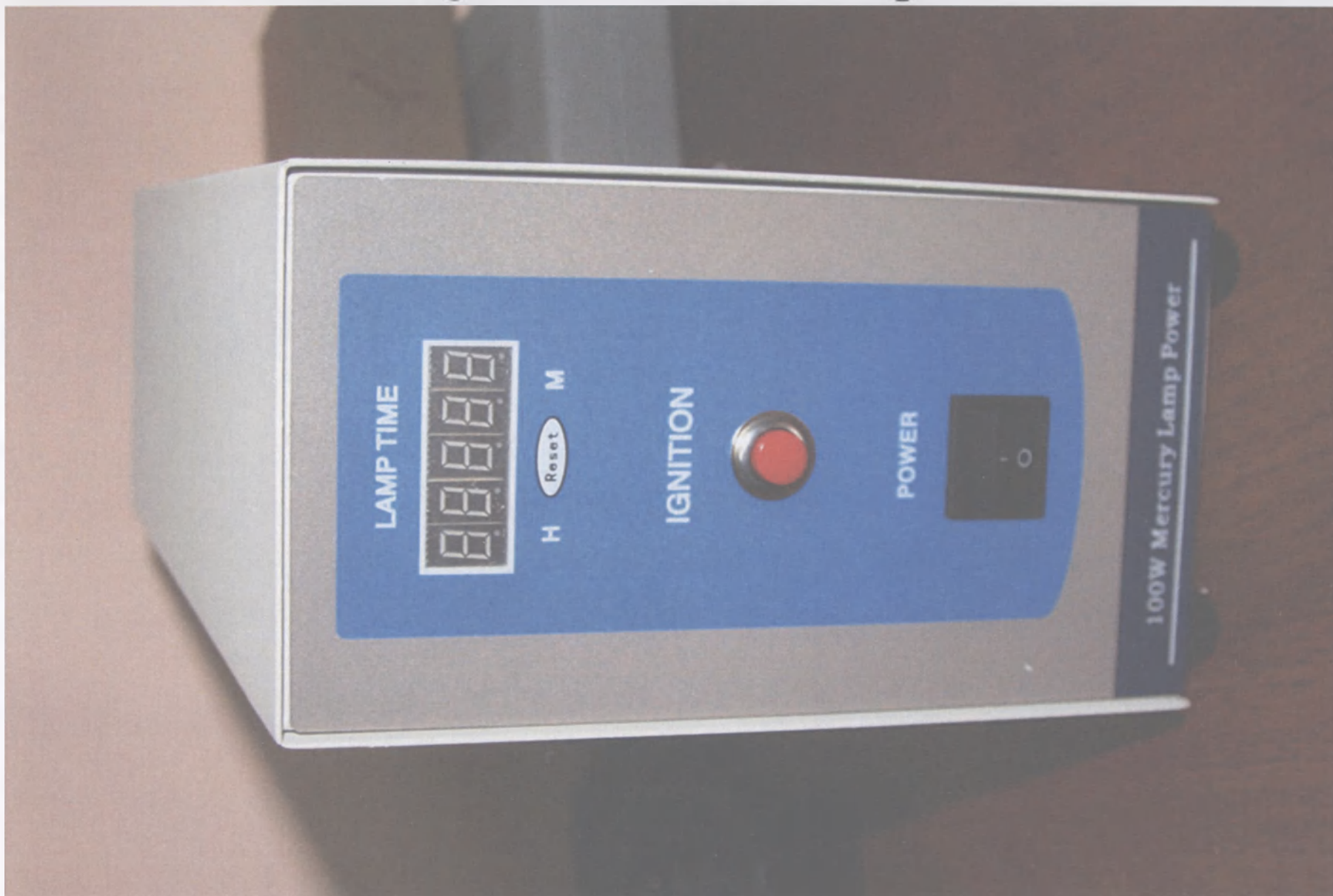
208. Внешний блок питания ртутной лампы для флуоресценции (100Вт, (100-240)В, (50/60) Гц)
