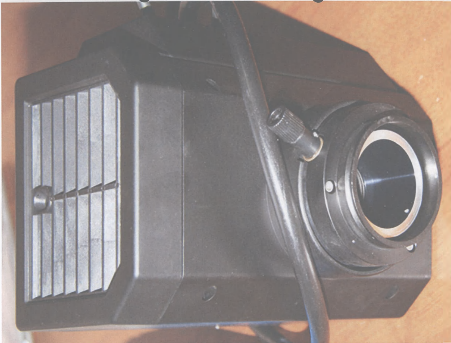
277. Корпус осветителя ртутного флуоресцентного
