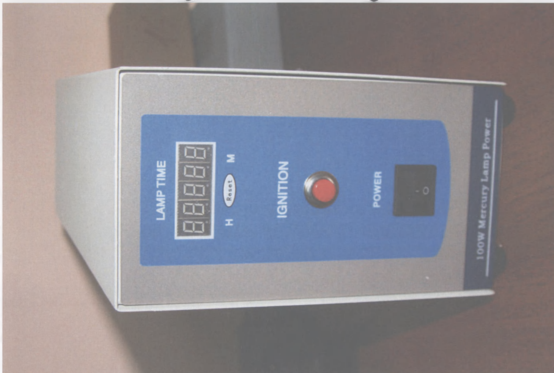
135. Внешний блок питания ртутной лампы для флуоресценции (100Вт, (100-240)В, (50/60) Гц)
