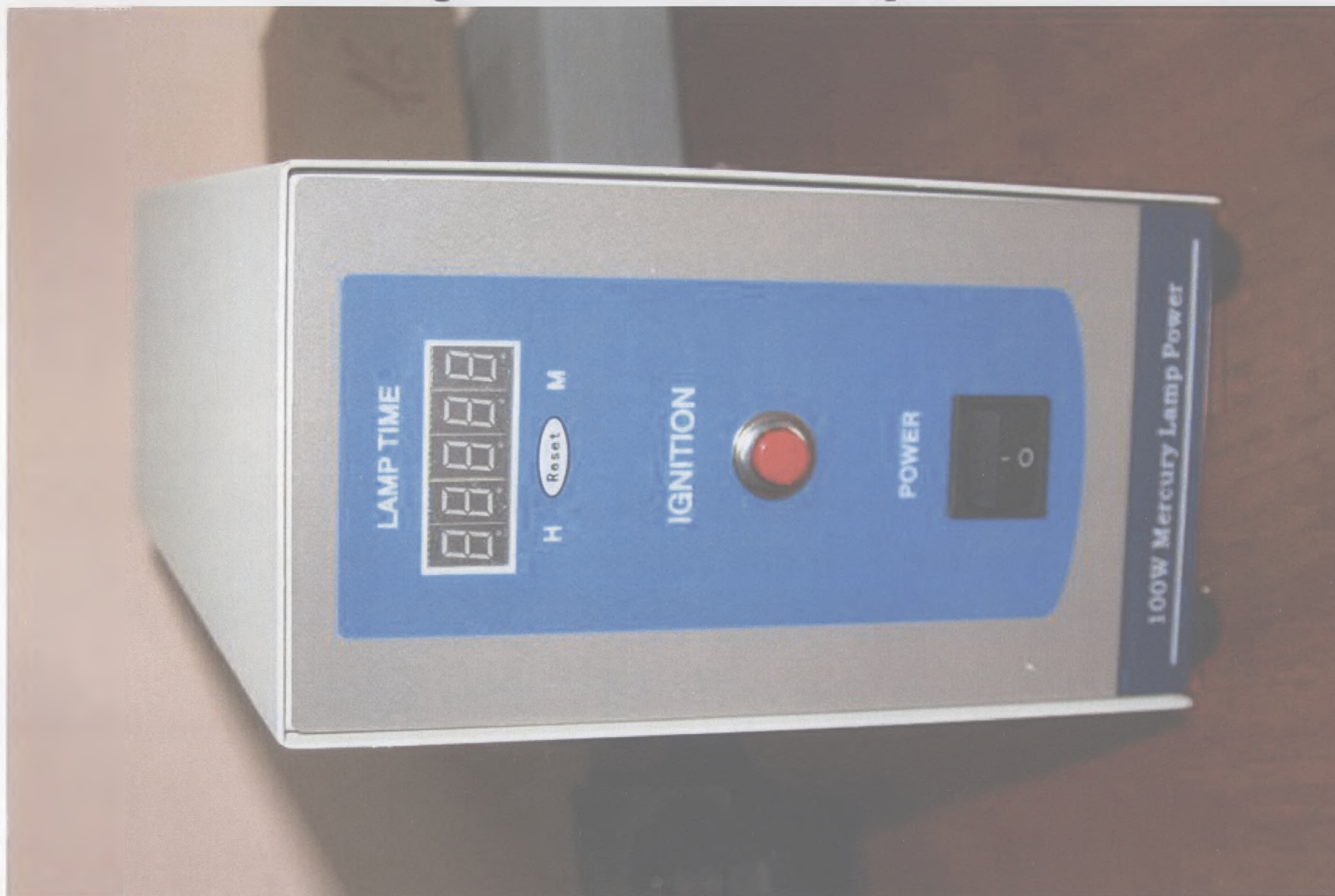
26. Внешний блок питания ртутной лампы для флуоресценции (100Вт, (100-240)В, (50/60) Гц)
