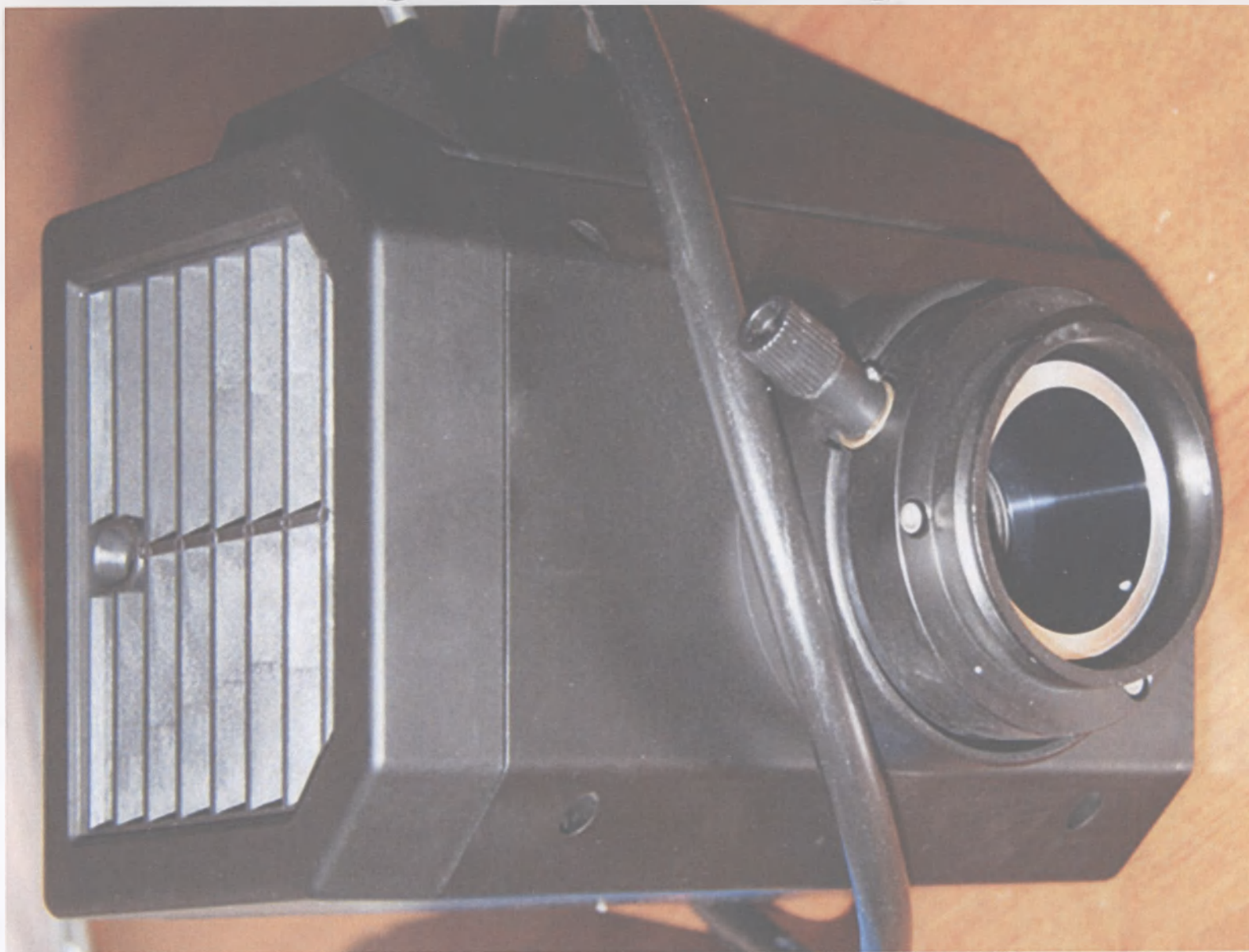
206. Корпус осветителя ртутного флуоресцентного
