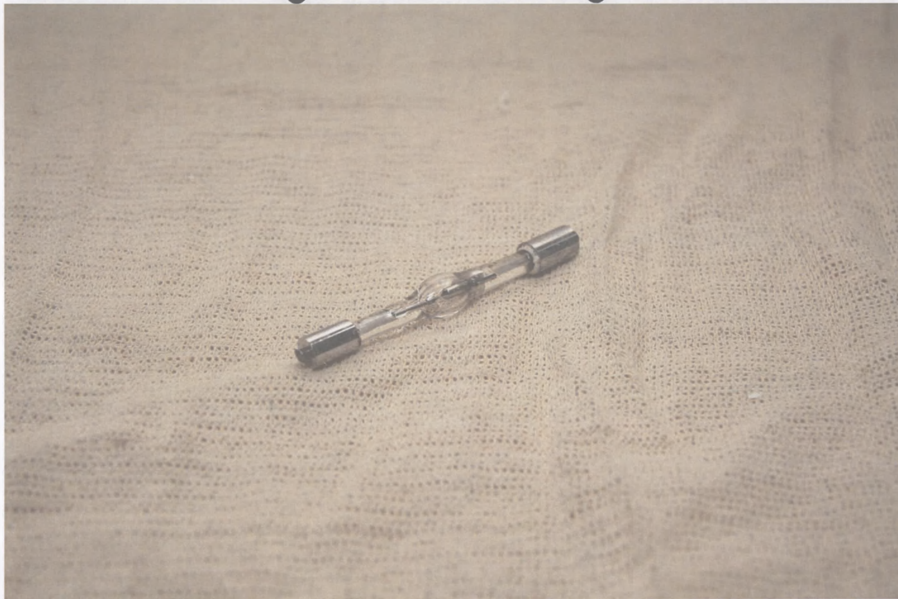
25. Лампа ртутная флуоресцентная на 100W
