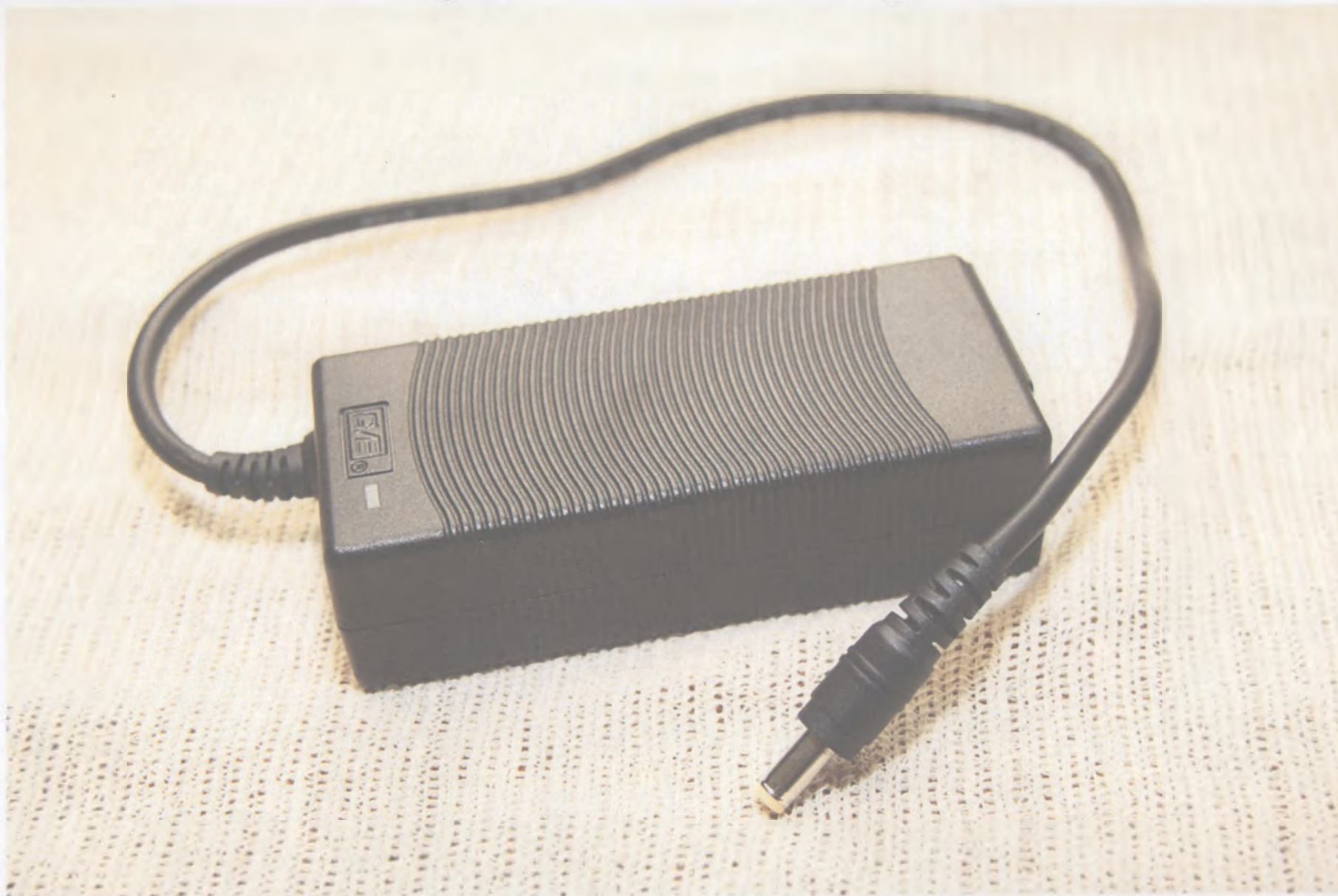
138. Внешний блок питания светодиода флуоресцентного (3Вт, (100-240)В, (50/60) Гц)
