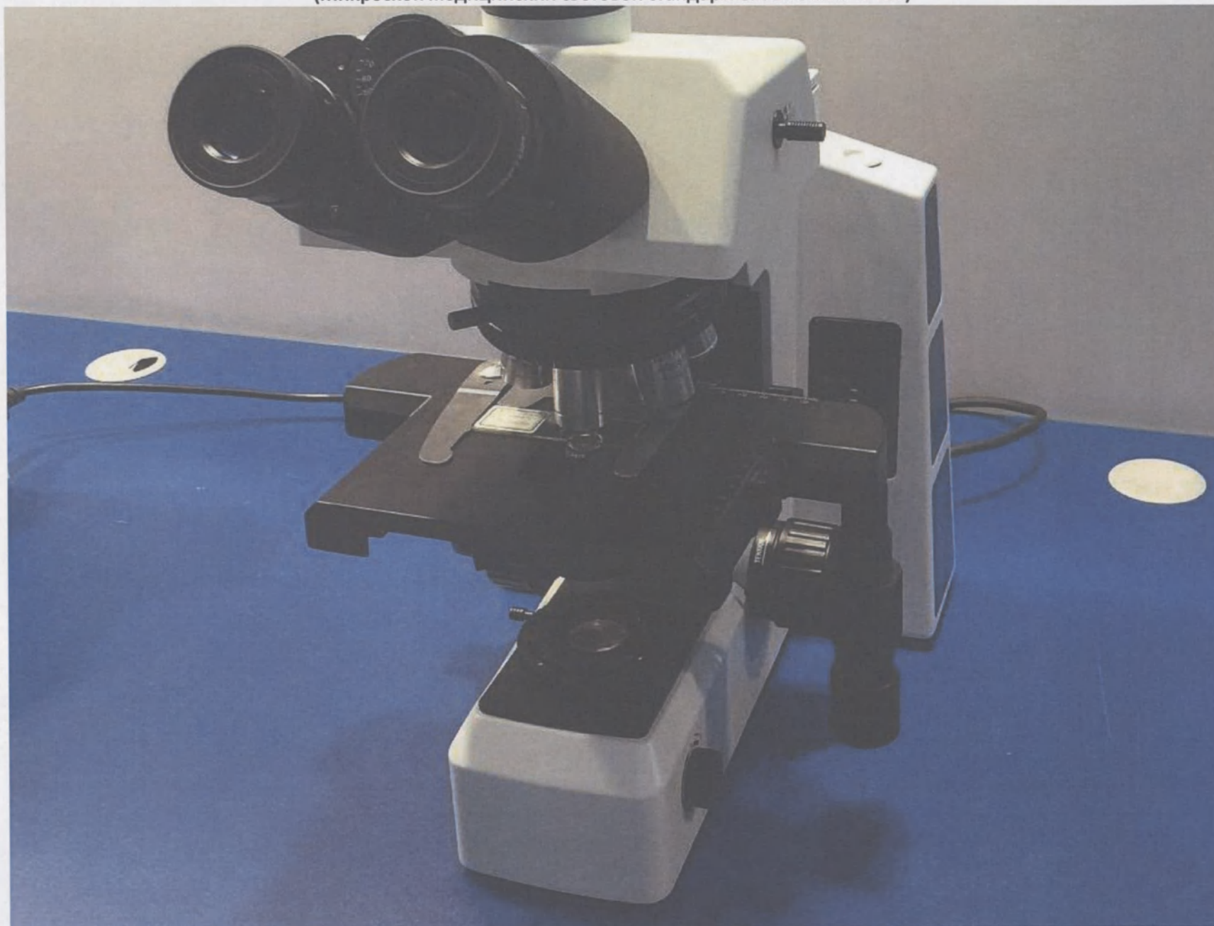
1. Штатив микроскопа БиОптик С-400 с галогенным источником света
