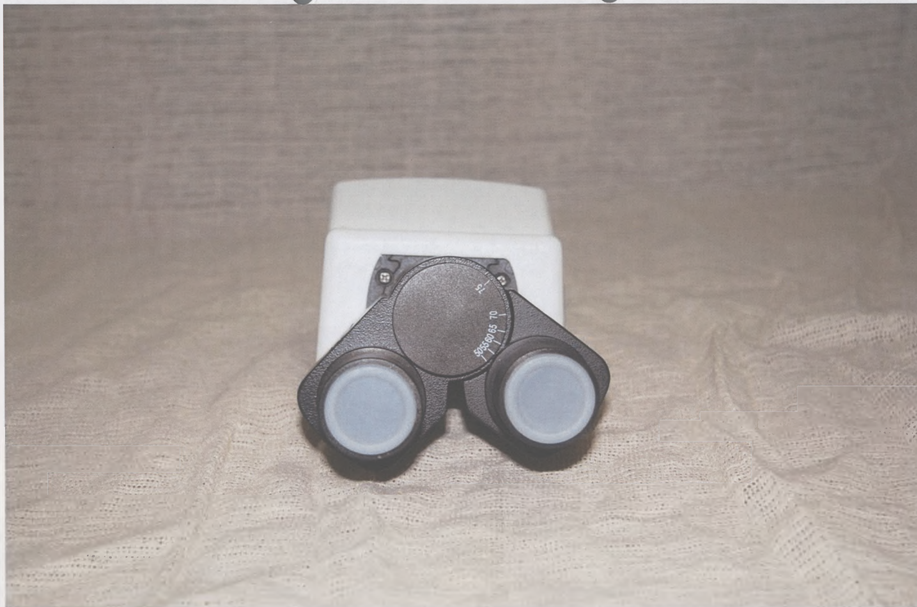
1. Тубус бинокулярный, угол наклона 30^\circ , вращаемый на 360^\circ , межзрачковое расстояние 50-75 мм
