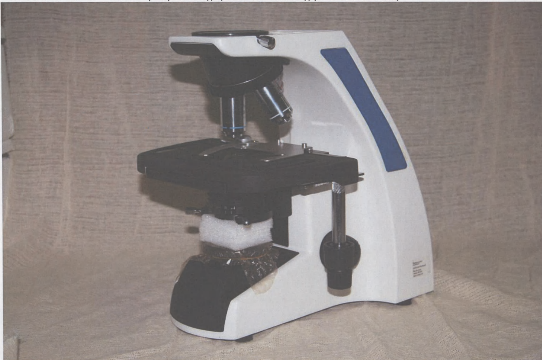
1. Штатив микроскопа БиОптик В-300 с галогенным источником света
