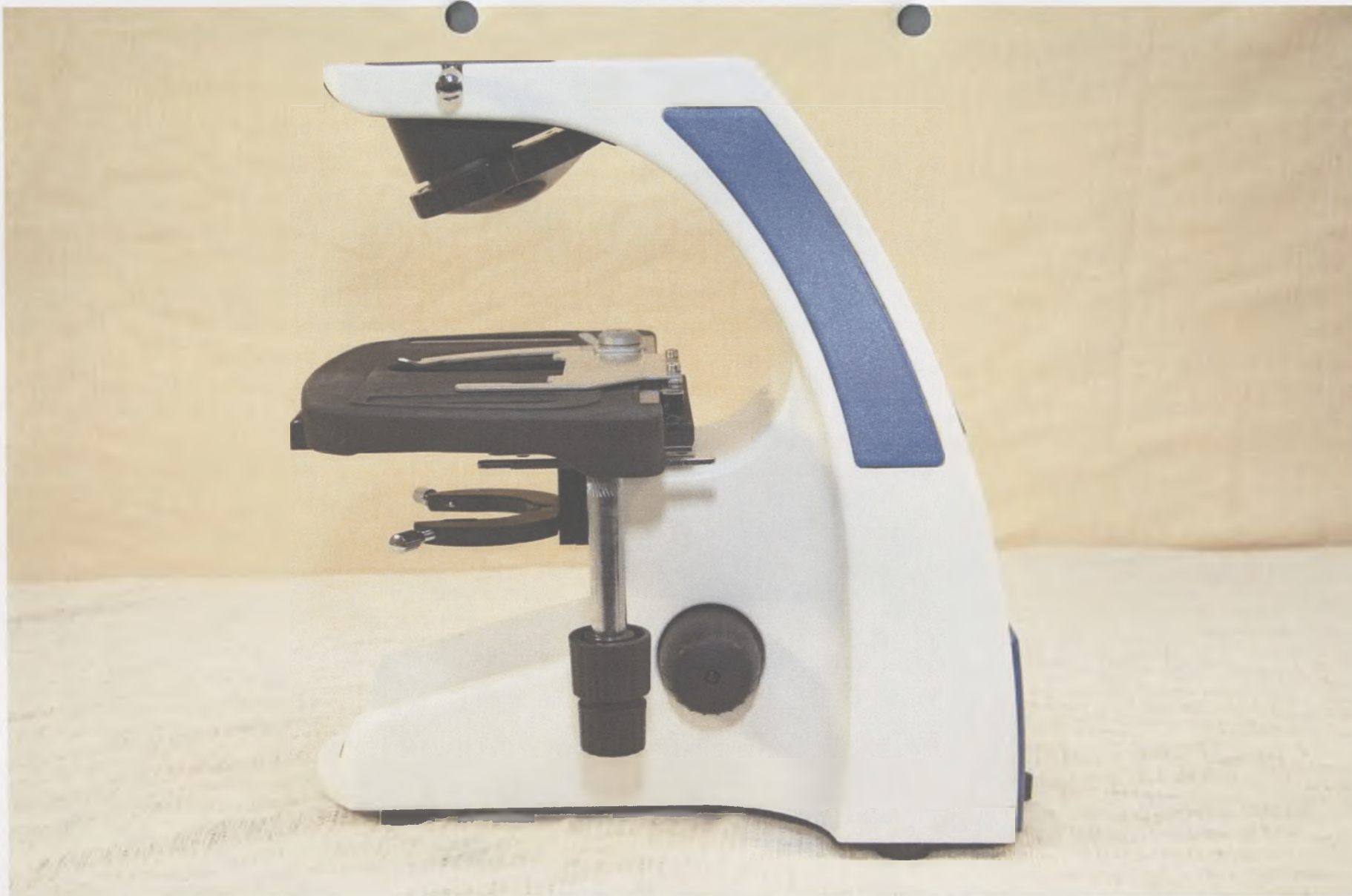
2. Штатив микроскопа БиОптик В-300 со светодиодным источником света
