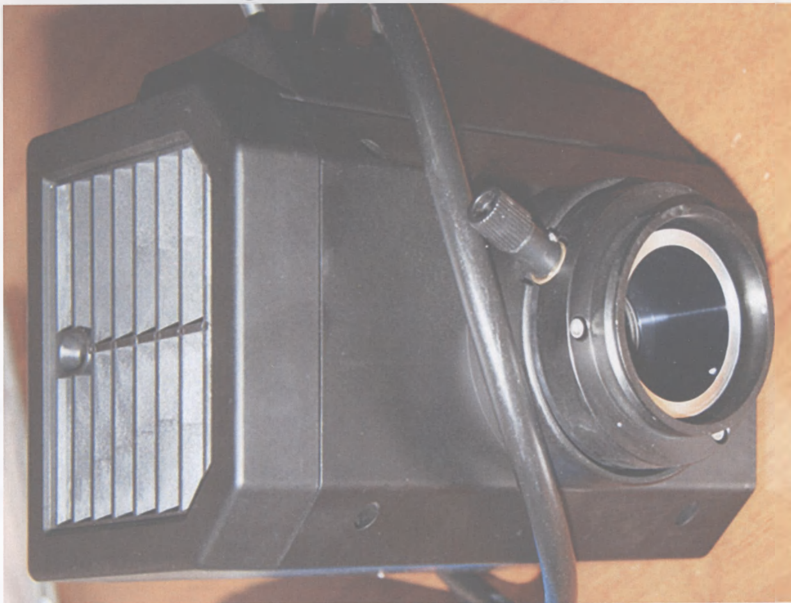
133. Корпус осветителя ртутного флуоресцентного
