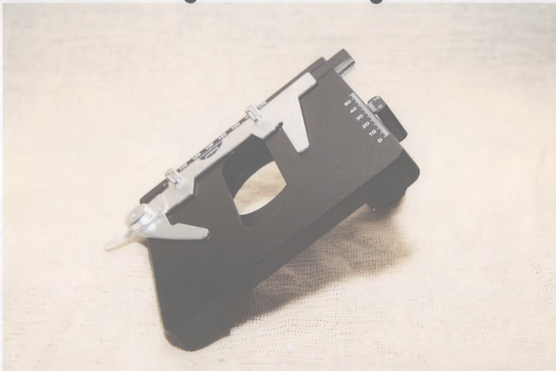
243. Предметный столик прямоугольный с координатным перемещением препарата размером 187x166 мм, диапазон перемещения препарата 80x55 мм
