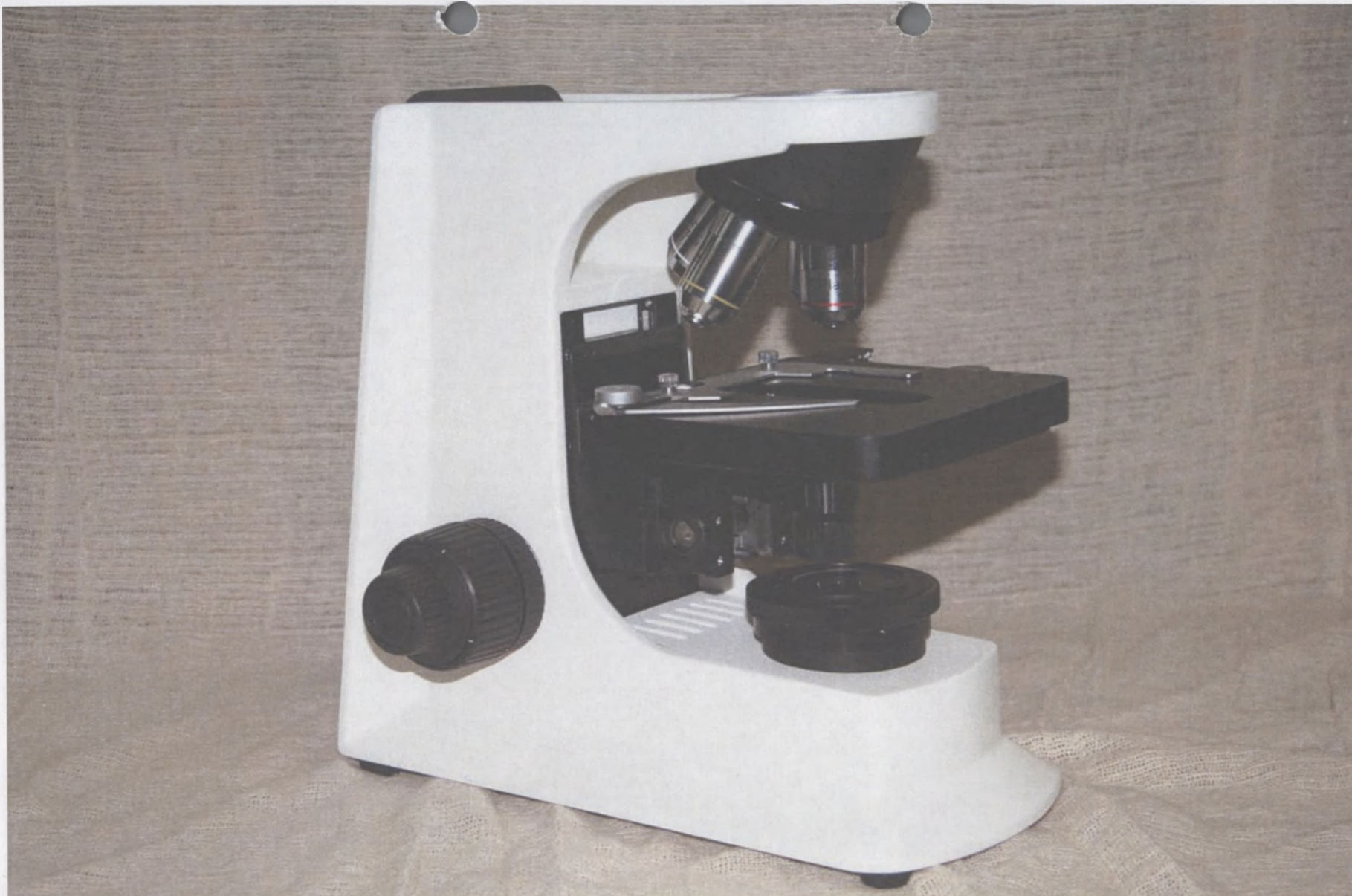
2. Штатив микроскопа БиОптик В-200 со светодиодным источником света
