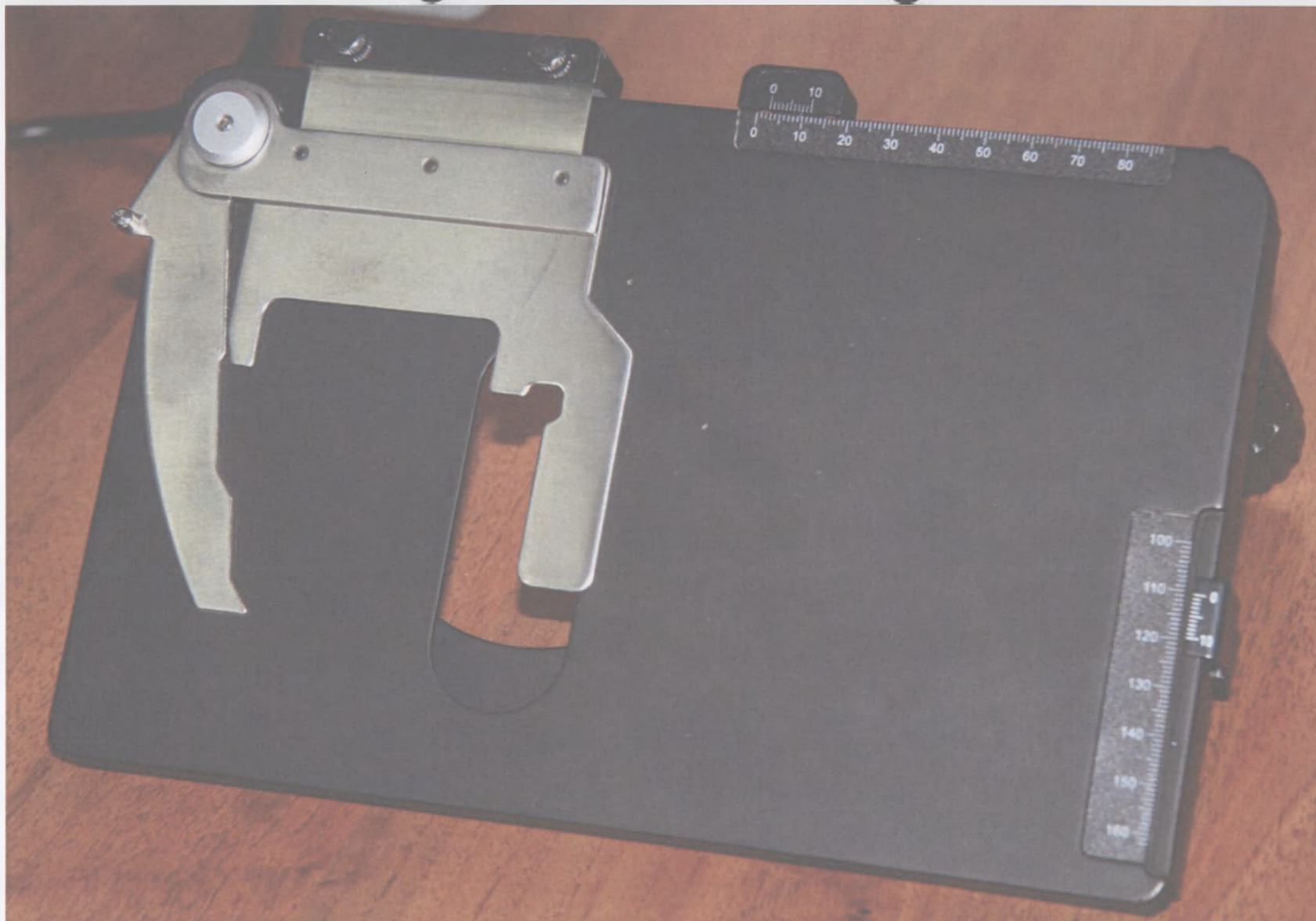
167. Предметный столик прямоугольный с координатным перемещением препарата размером 243x158 мм, диапазон перемещения препарата 75x55 мм
