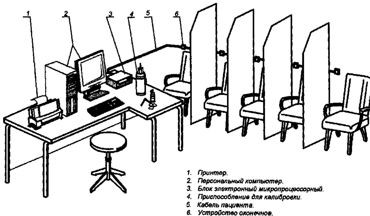
Рисунок 6 – Один из вариантов расположения прибора в гастроэнтерологической лаборатории
