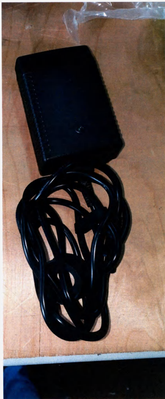
Рисунок 5 – Блок питания для непосредственной зарядки ручного блока (во время транспортировки) или посредством установочной станции.
