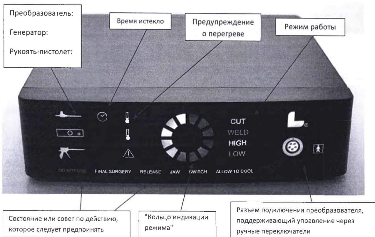
Рисунок 2: Основные конструктивные элементы передней панели генератора
