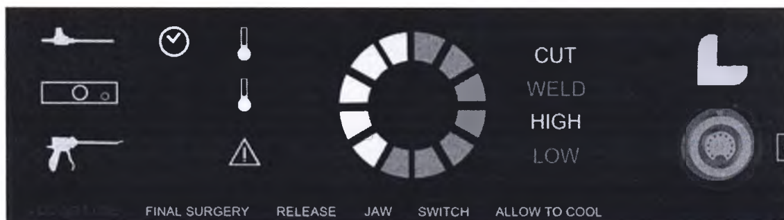
Рисунок 4: Индикаторы состояния, неисправности и указаний
