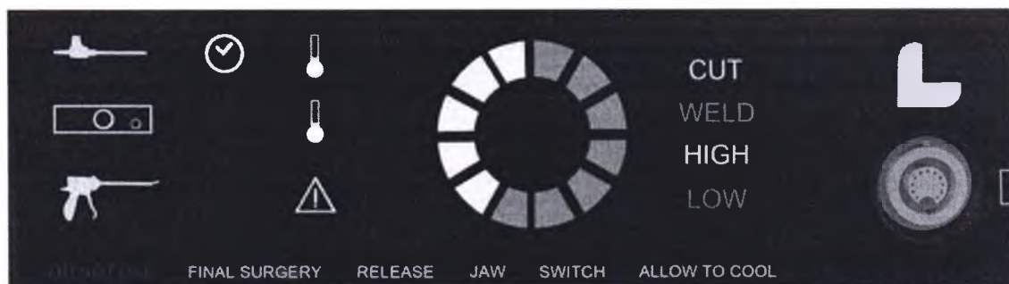
Рисунок 4: Индикаторы состояния, неисправности и указаний
