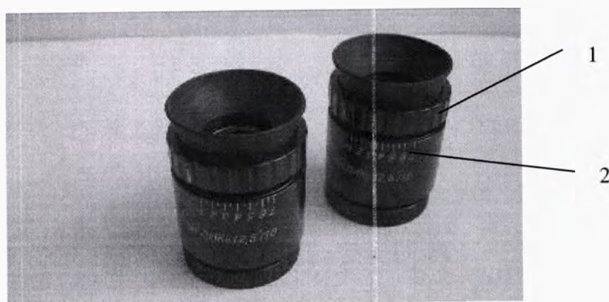
1 – диоптрийное кольцо, 2 шкала диоптрийной подвижки
