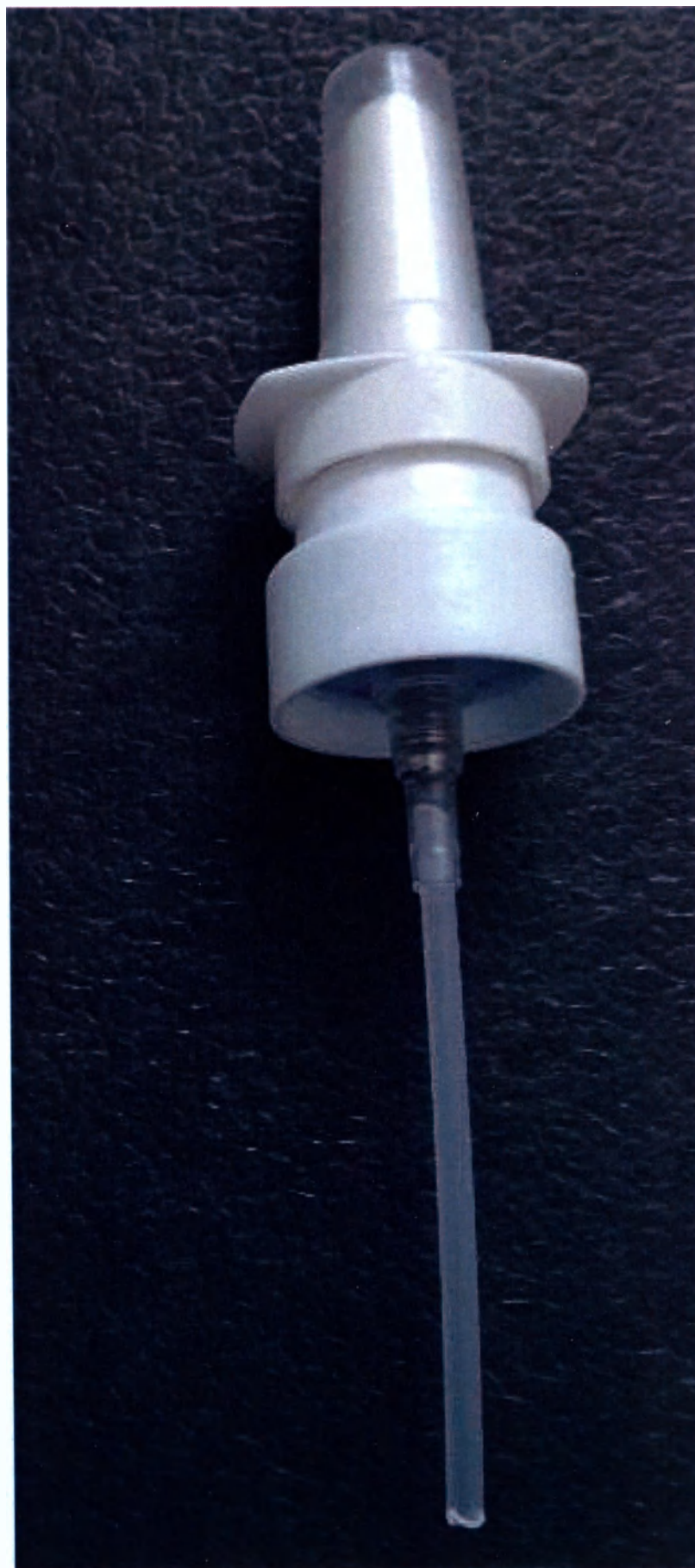
Рис.6 – Защелкивающийся насос-дозатор механический семейства Classic для многократного дозирования с актуатором для назального распыления лекарственных средств в исполнении 100 мкл;
