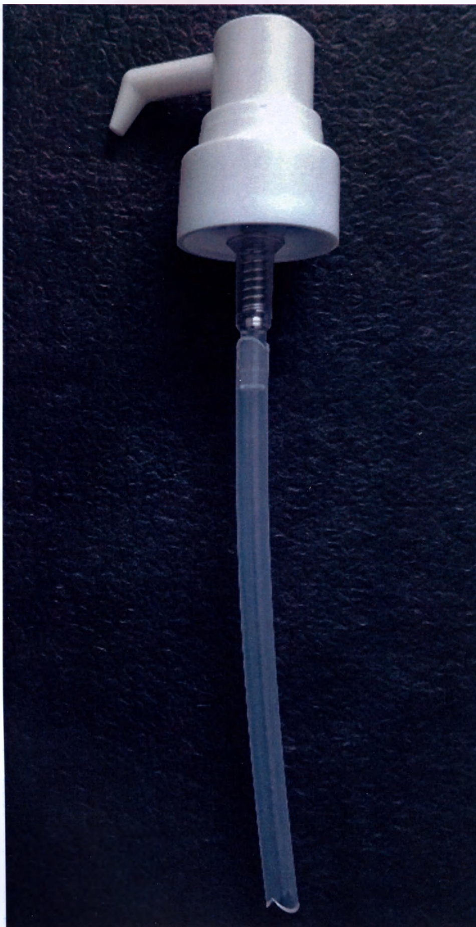
Рис.14 – Защелкивающийся насос-дозатор механический семейства Classic для многократного дозирования с актуатором для капельного распыления лекарственных средств в исполнении 140 мкл;
