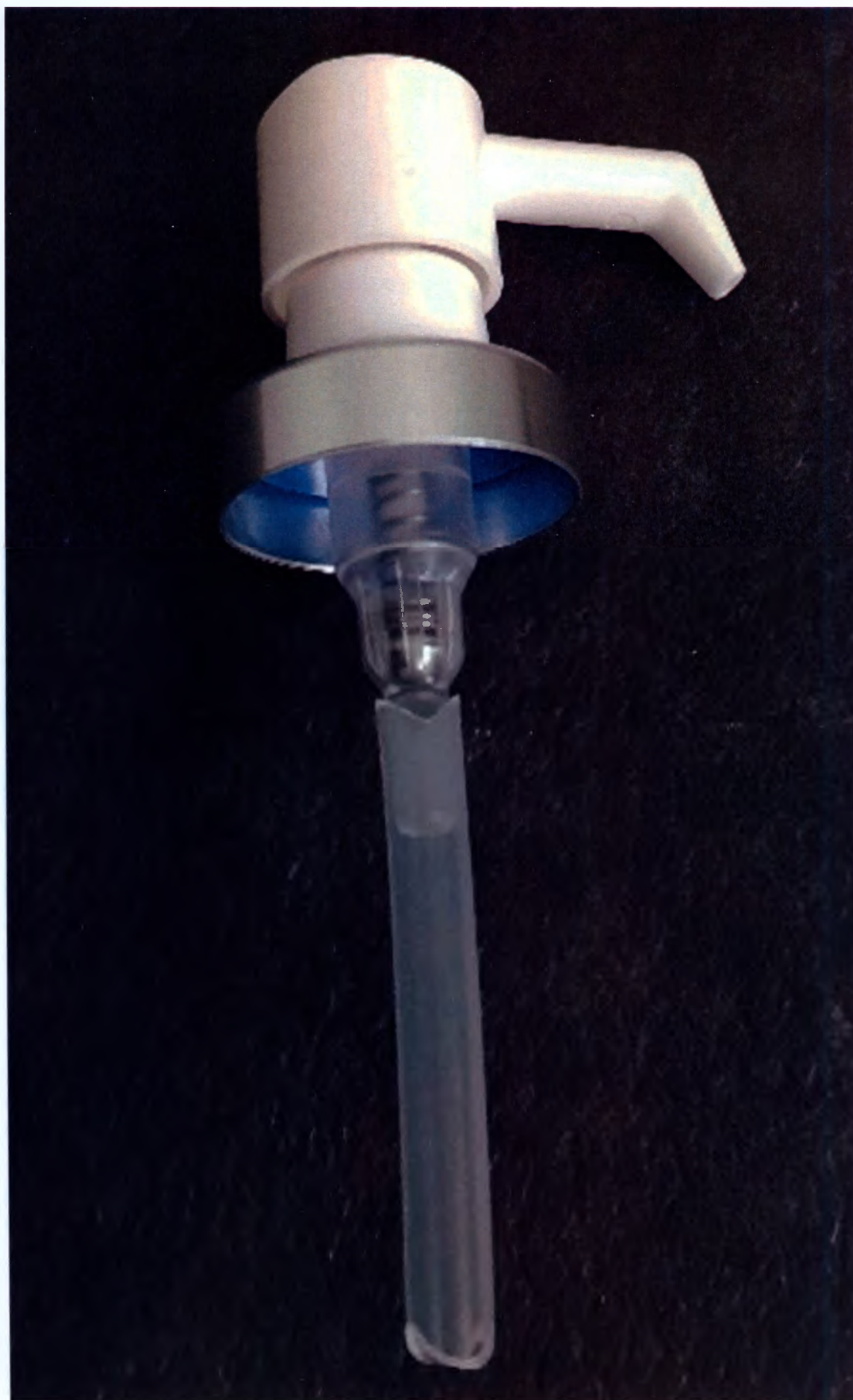
Рис.13 – Зажимной насос-дозатор механический семейства Classic для многократного дозирования с актуатором для капельного распыления лекарственных средств в исполнении 140 мкл;
