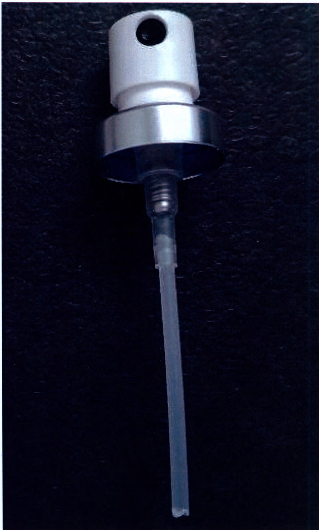
Рис.10 – Зажимной насос-дозатор механический семейства Classic для многократного дозирования с актуатором для наружного распыления лекарственных средств в исполнении 45 МКЛ;
