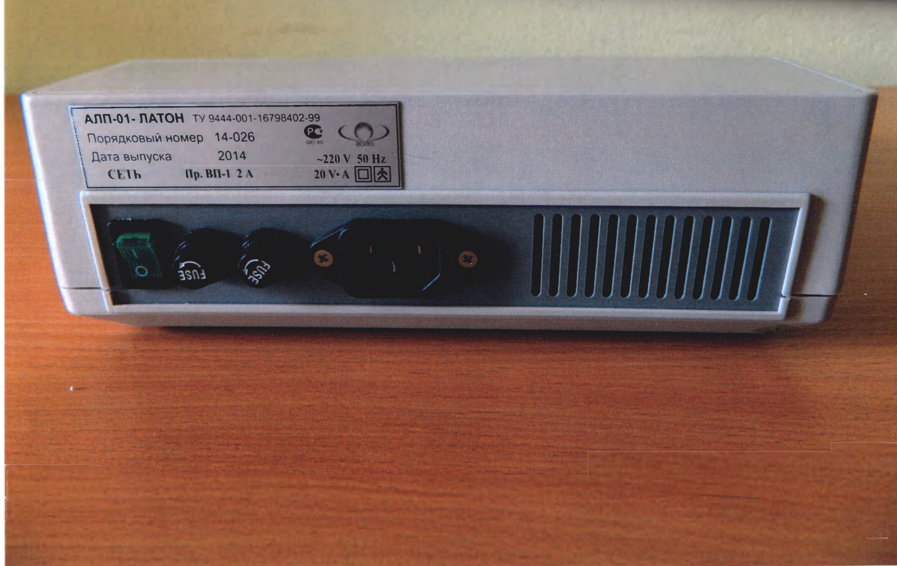
Аппарат лазерный полупроводниковый К- и ИК-излучением, с волоконно-оптическими световодами для чрескожной и внутриполостной терапии «АЛП-01-«Латон». Маркировка на задней панели
