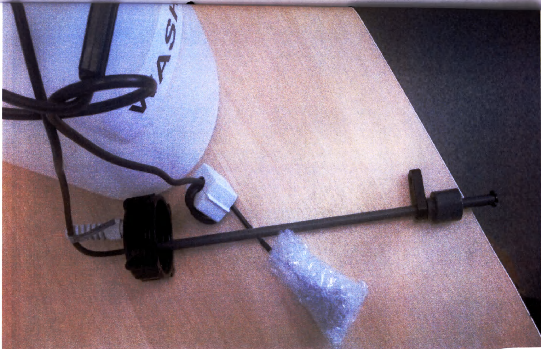
Рисунок 31. Датчик уровня воды
