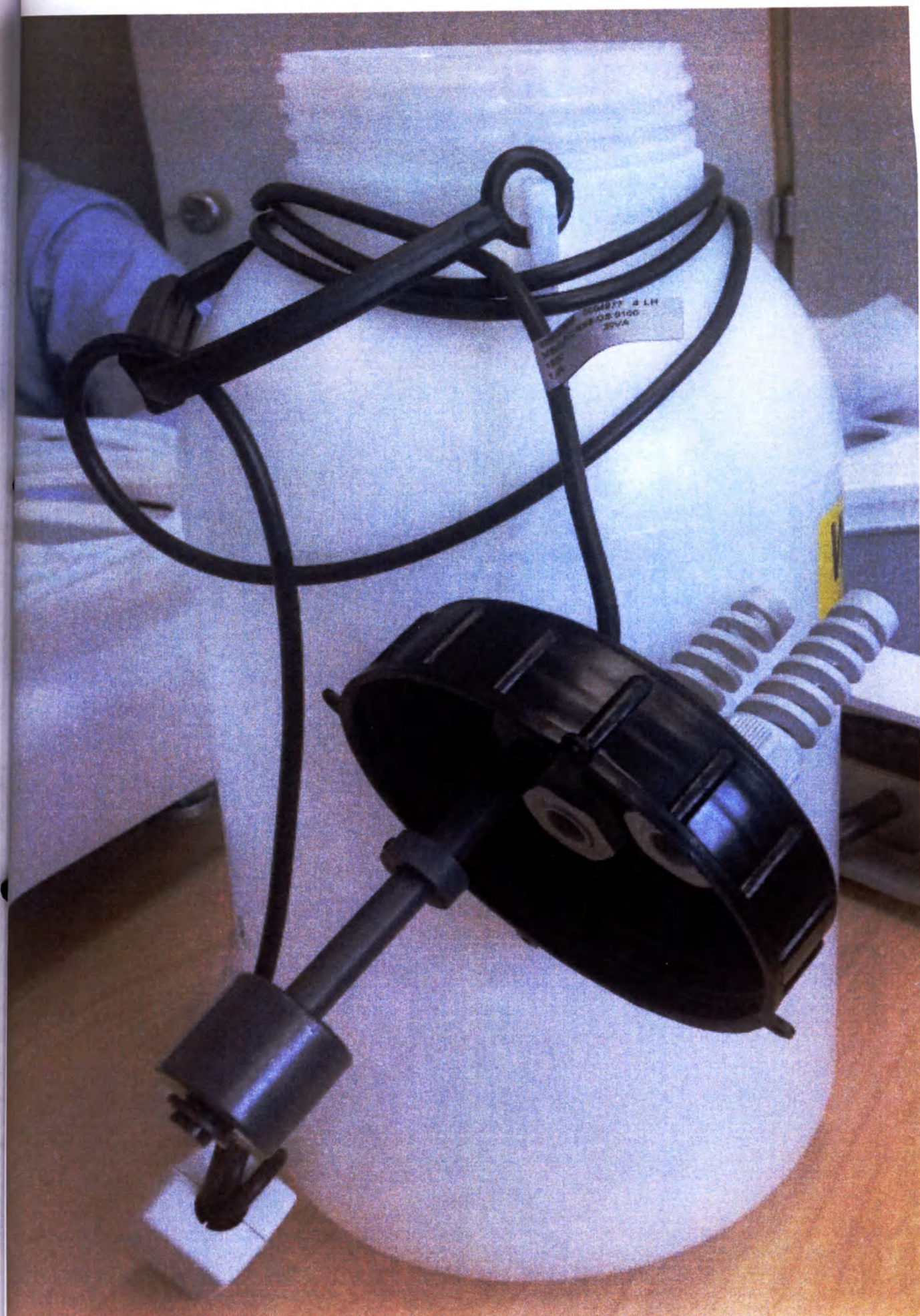
Рисунок 30. Датчик уровня отходов;
