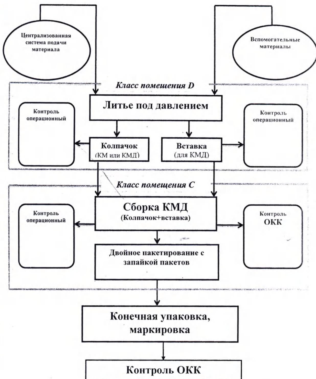
Рис. 1 - Схема технологического процесса изготовления колпачков
