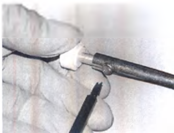
Удаление винта из точечного источника
