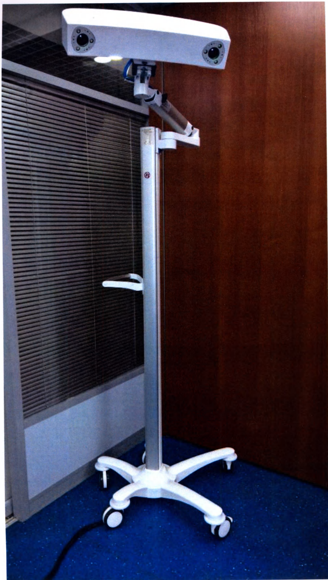
Стереокамера на хирургической стойке с кронштейном
