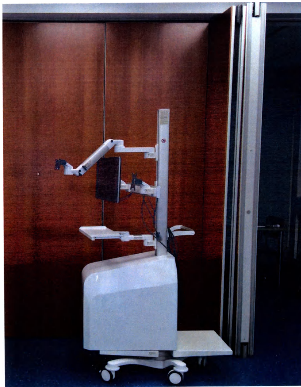
Хирургическая стойка для ToF и POV камер с кронштейном
