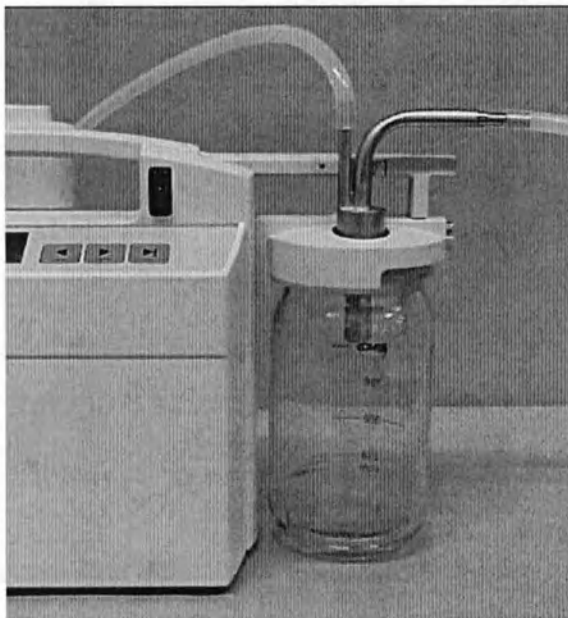
Рис.9. Насаживание отсасывающего шланга
