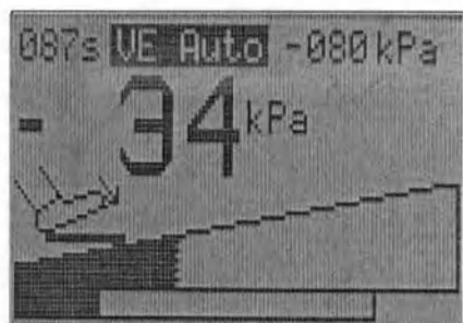
Рис.29. Пример: Нажатие на переднюю часть ножного регулятора приведет к переключению контроля уровня вакуума на ножной регулятор на уровне примерно -34 кПа.
