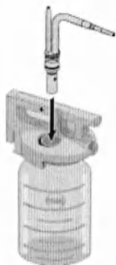
Рис.7. Использование двоянной соединительной трубки
