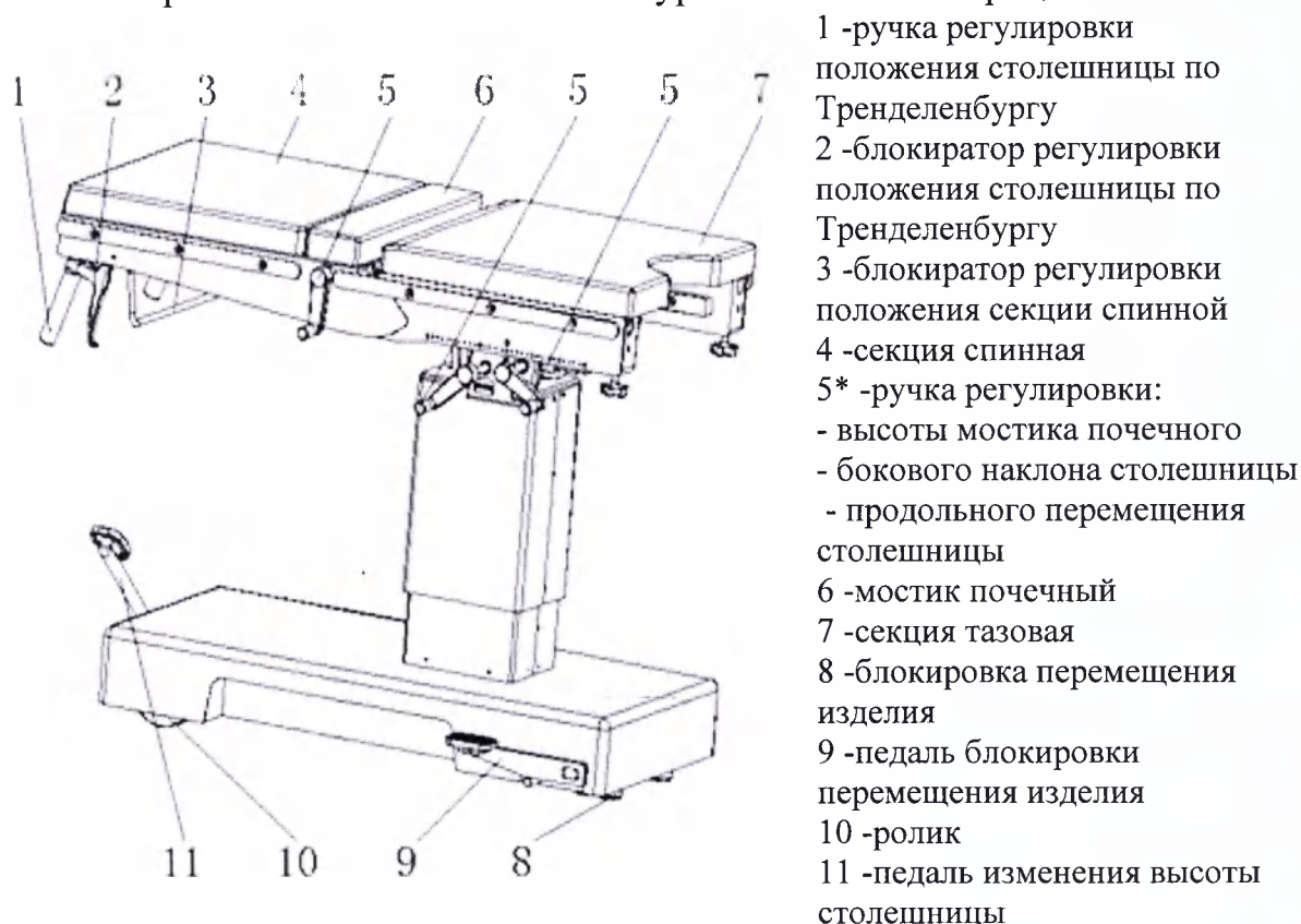
Рис. 2 Устройство стола операционного механогидравлического «Лидкор» (продолжение).
