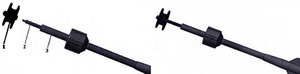
Рисунок 4 – Соединение окклюдера с толкателем системы доставки
