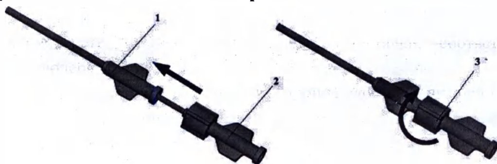
Рисунок 2 – Соединение расширителя с доставочным катетером
