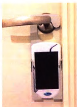
Рисунок 40 – Пример размещения Пульта на входной двери в обрабатываемое помещение
