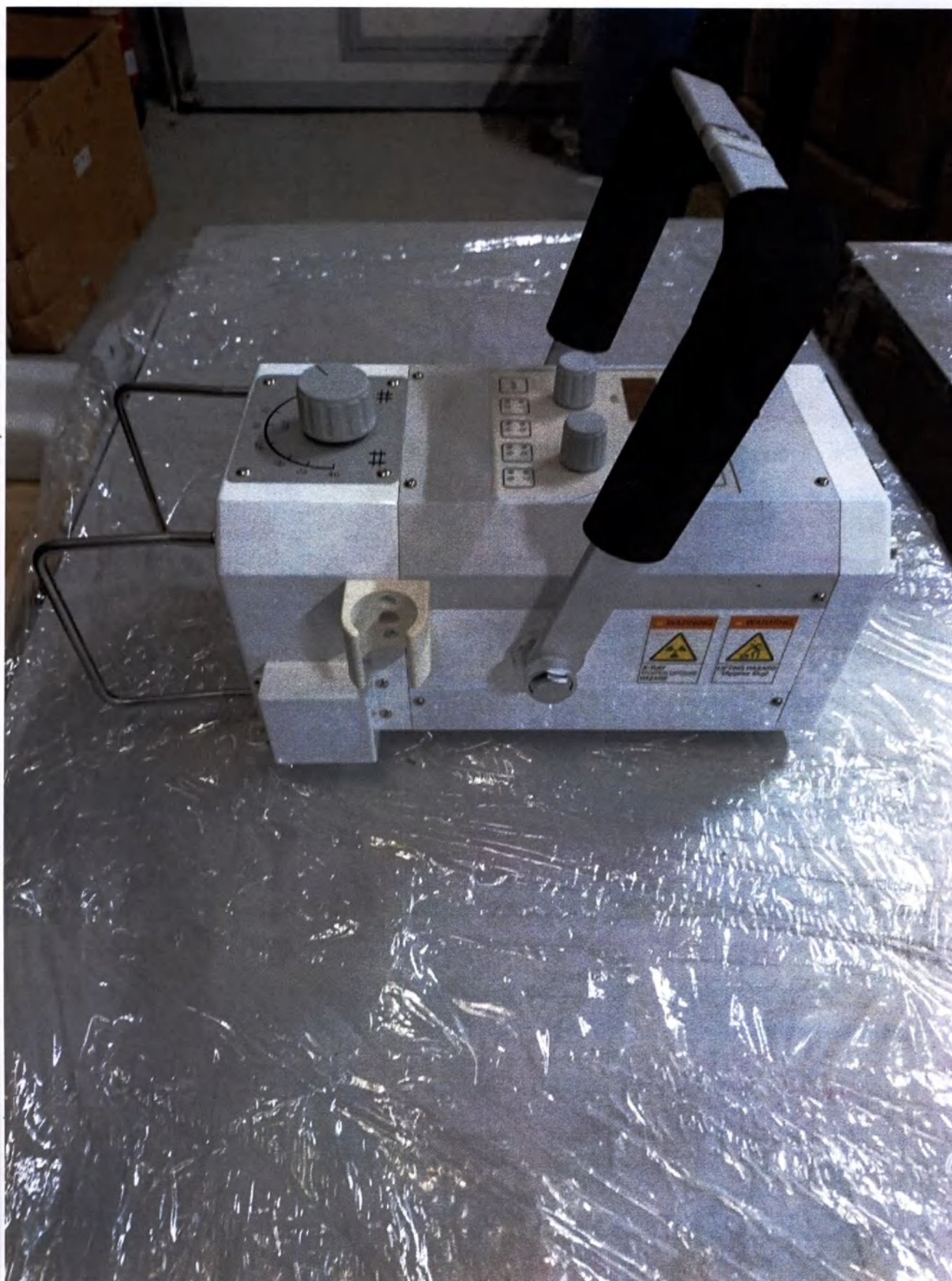
Рис.5. Рентгеновский генератор и контроллер рентгеновского излучения (моноблок) с коллиматором (вид сбоку (справа))
