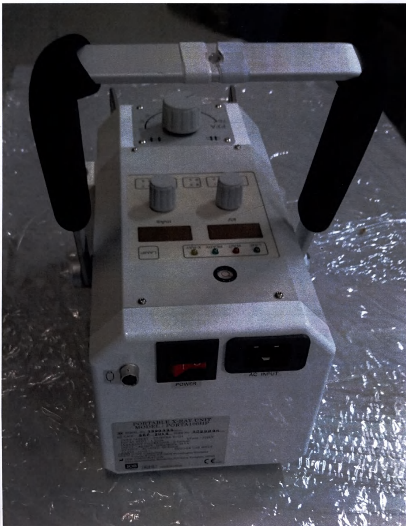
Рис.3. Рентгеновский генератор и контроллер рентгеновского излучения (моноблок) с коллиматором (вид сзади)
