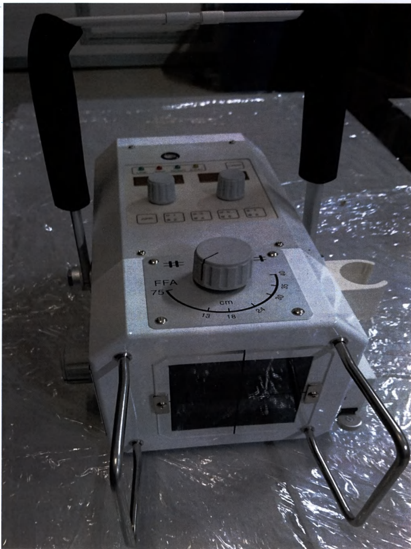
Рис.2. Рентгеновский генератор и контроллер рентгеновского излучения (моноблок) с коллиматором (вид спереди)
