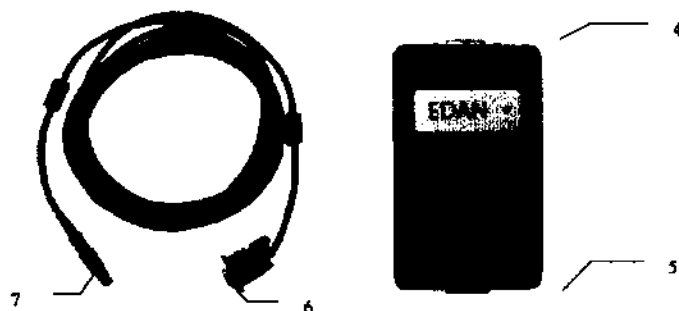
Кабель 1 (экранированный ЭКГ кабель RS485)
