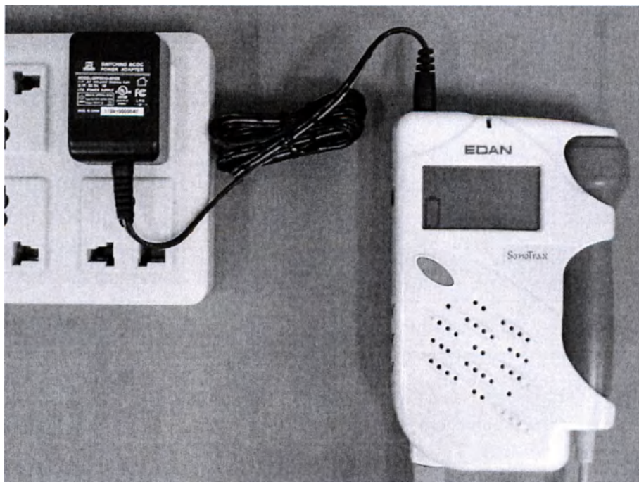
Рисунок 3-7. Зарядка блока никель-металлогидридных аккумуляторов
