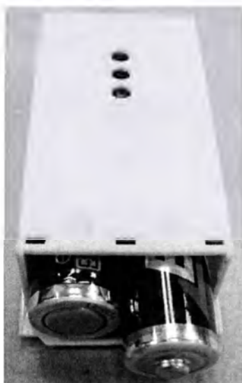
Рисунок 3-2. Установка батарей на крышку отсека
