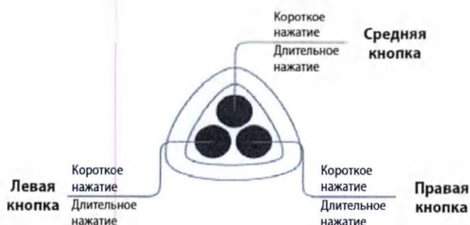
Рисунок 3. Автоклавируемая головка эндовидеокамеры LENS от «Смит энд Нэфью»
