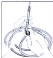
Рисунок 11. Проверка волоконно-оптического световодного кабеля
