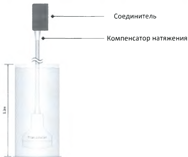
Рисунок 10-1 Уровень погружения IPX8
