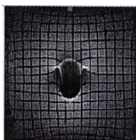
Рис. 2. Наихудшие артефакты в корональном изображении КМИ SJM Confirm, полученном с использованием спин-эхо последовательности.
