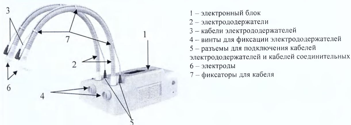
Рисунок 9 Установка электрододержателей
