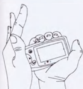
Рис. 31. Регистрация ЭКГ через ладонь. Держать электрокардиограф правой рукой, так, чтобы металлические электроды 1 и 2 находились в хорошем контакте с ладонью и пальцами правой руки и присоединить электрод 3 к ладони левой руки (см. Рис. 32). Измеренная форма волны с использованием метода измерения на ладони эквивалентна с формой волны I-отведения ЭКГ.
