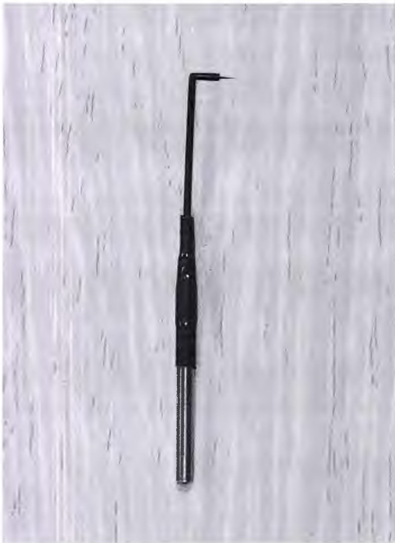
Фото 26 – Внешний вид изделия для варианта исполнения: Электрод-игла вольфрамовый для микро-надрезов: - Длина 40мм, с активным кончиком 2 мм, изогнутый под углом 90° на расстоянии 10мм от конца, ETS01-60E3-A902(N117A).
