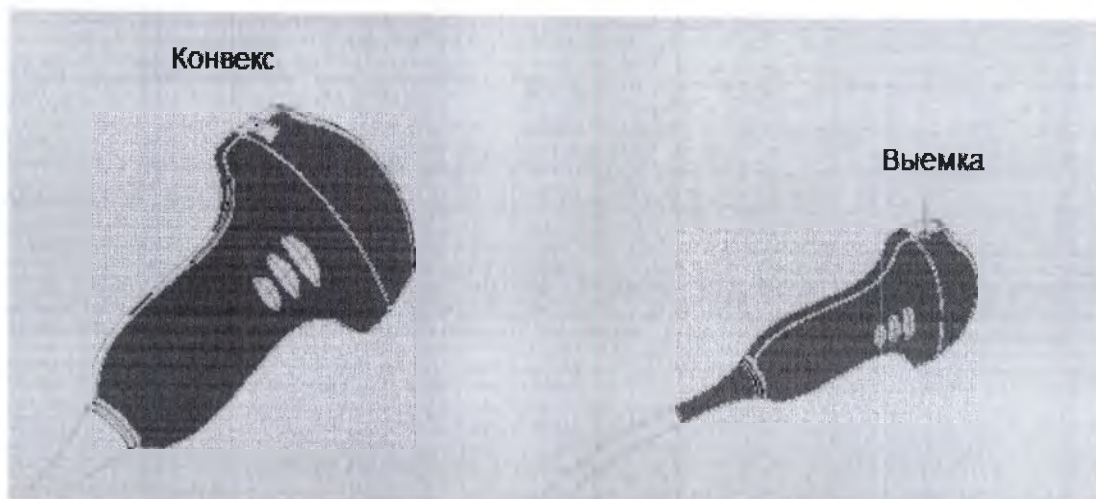
Рис. 4.3.4-4. Выемка на датчике
