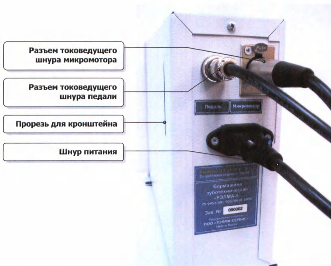
Рис. 4 – Подсоединение токоведущих шнуров к блоку управления
