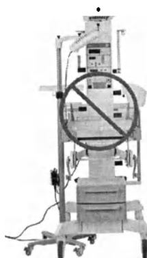
рис. 3-12 : Неправильное размещение светодиодной системы фототерапии при совместном использовании с нагревателем для новорожденных
