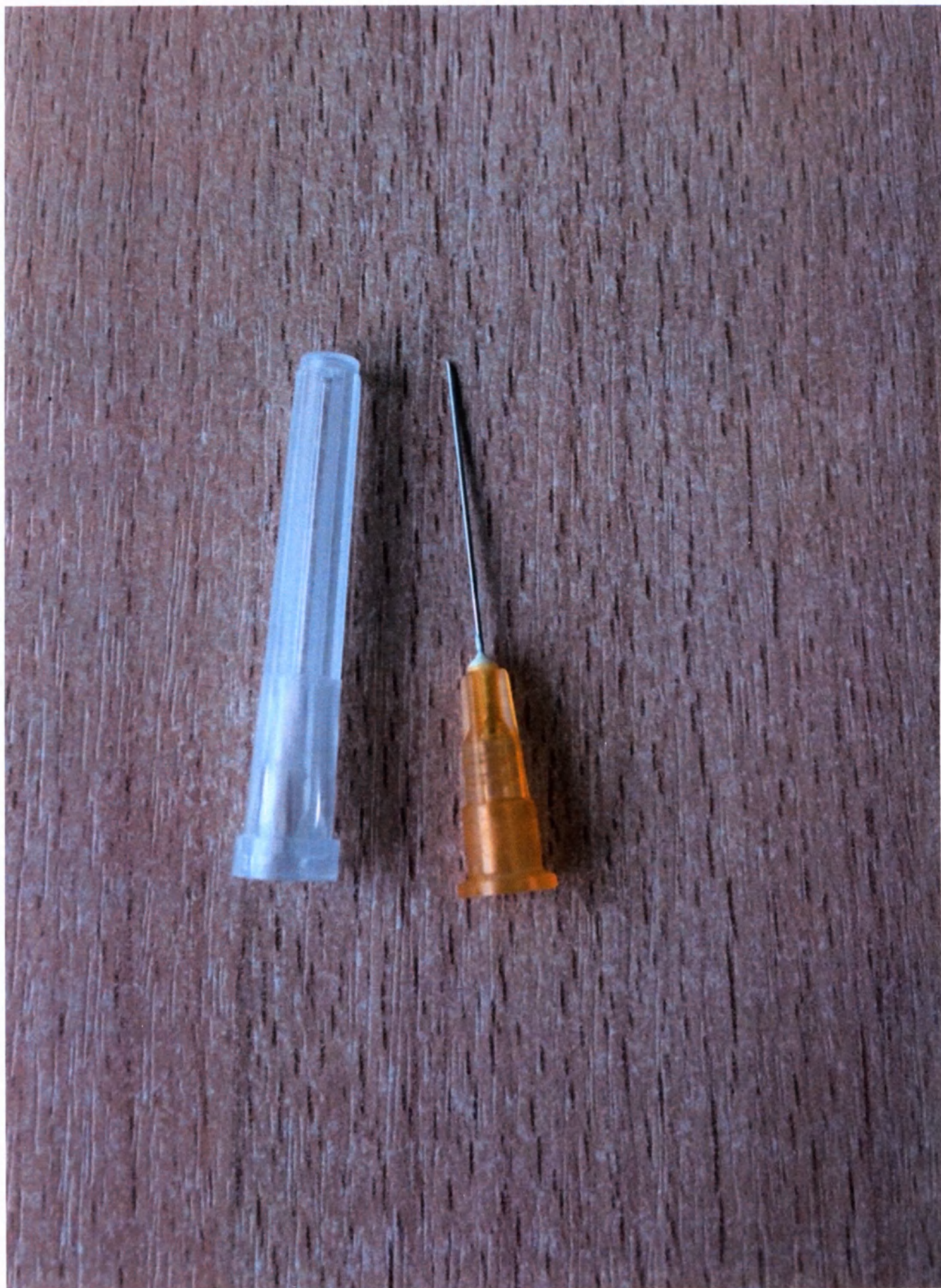
NN-2525R, наружный диаметр иглы 25G (0,5 мм), длина иглы 25 мм, длинный срез под углом 12°
