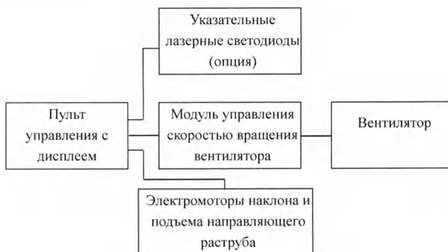
Рис. 1 – Общая схема «Серджин Эйр»
