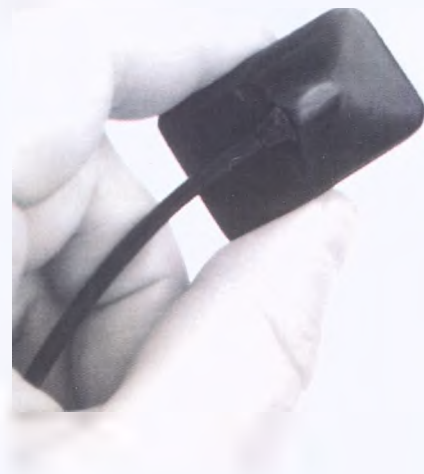
Задняя оболочка датчика: неактивная поверхность
