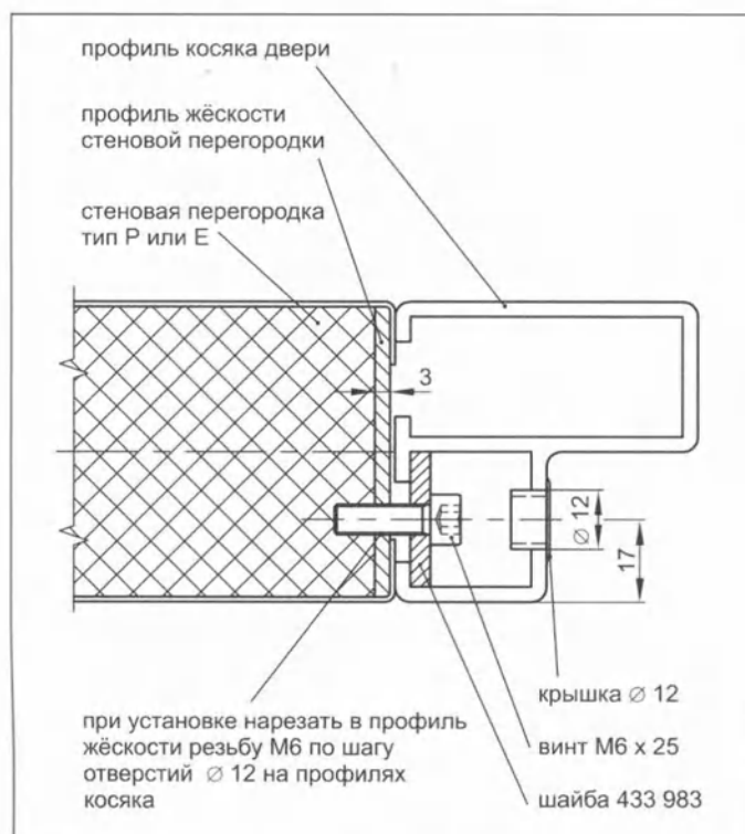
Рис.8 Способ крепления профиля косяка к стеновой перегородке тип Р или Е
