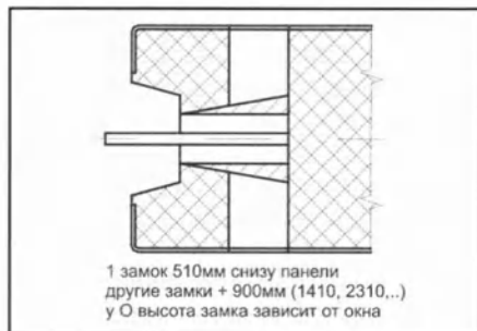
Рис. 5 М - замок с крючком, О - оконная, Z - съёмная, сторона с крючком
