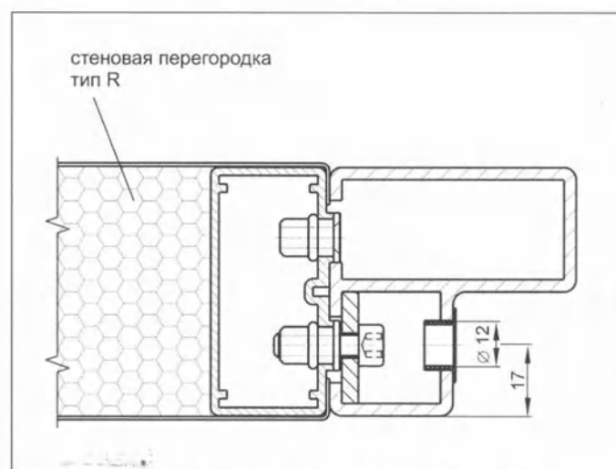
Рис.9 Способ крепления профиля косяка до стеновой перегородки тип R
