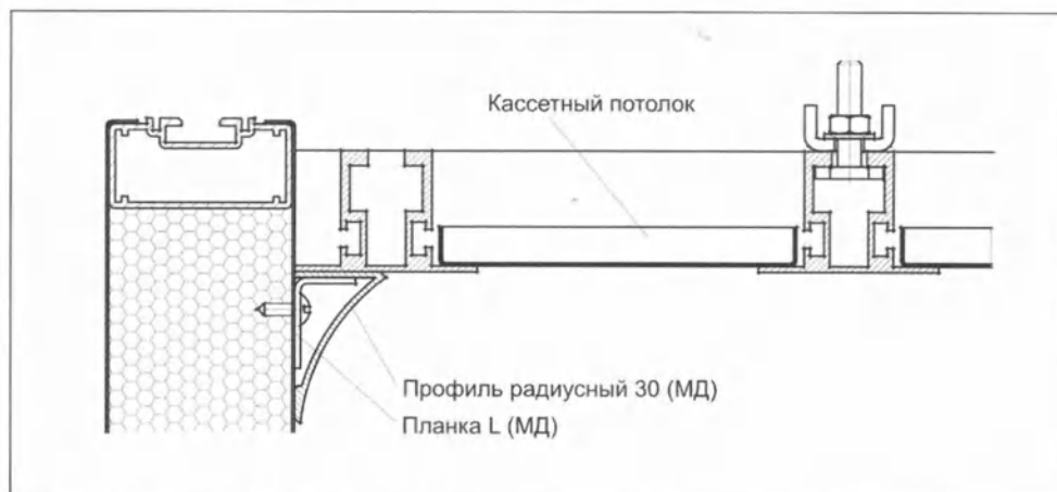
Рис.18 Укрепление кассетного потолка
