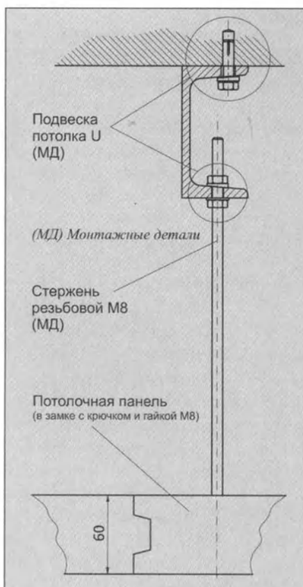
Рис. 5 Крепление набора в строительный потолок с помощью Подвески потолка U
