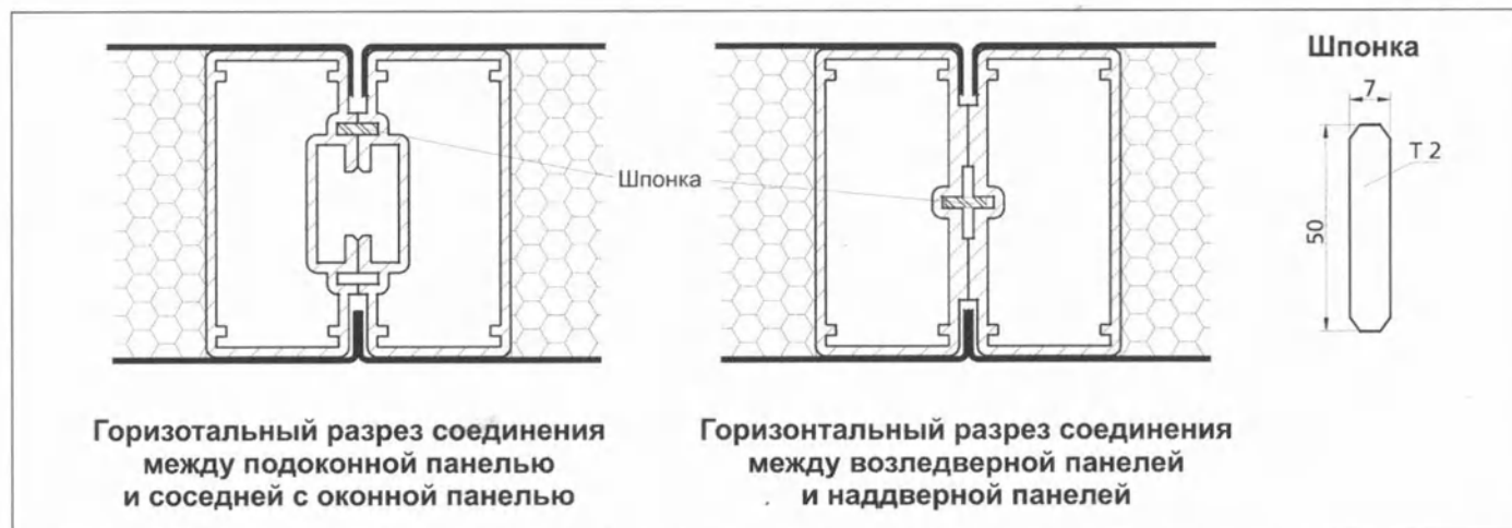
Рис.5 Соединение панелей при помощи шпонки
