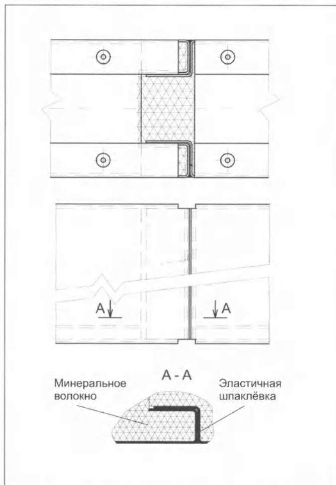
Рис.20 Стеновая панель в исполнении М
