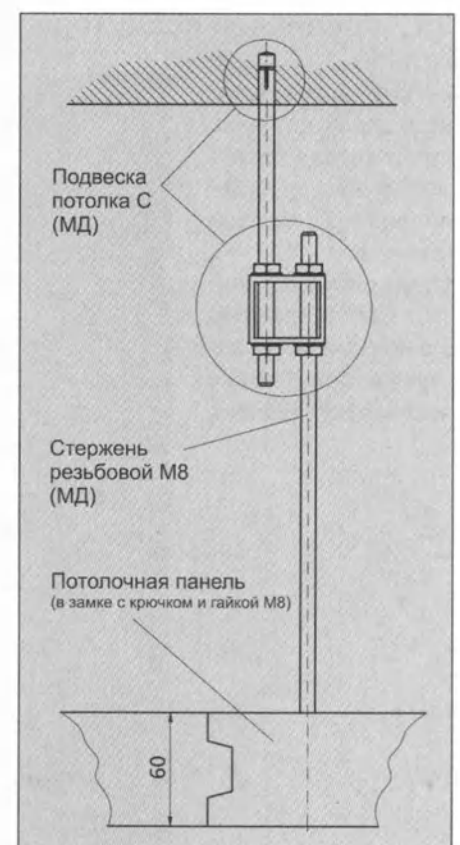
Рис. 7 Удлинение резьбового стержня или регулировка вертикального положения панельного потолка с помощью Подвески потолка C
