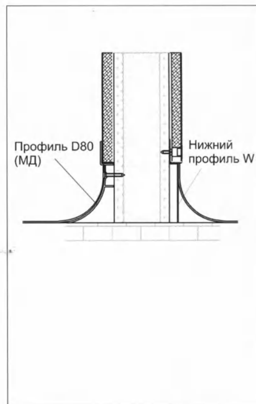
Рис. 8. Закрепление панелей у пола
