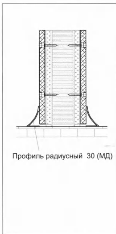
Рис. 7. Закрепление панелей у пола
