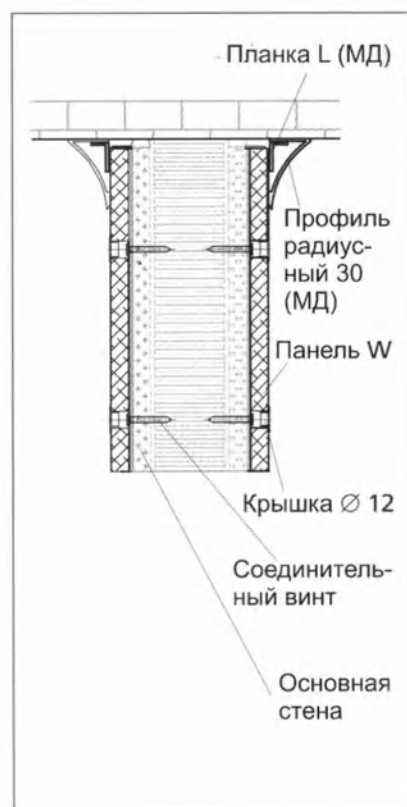
Рис. 6. Закрепление панелей у потолка
