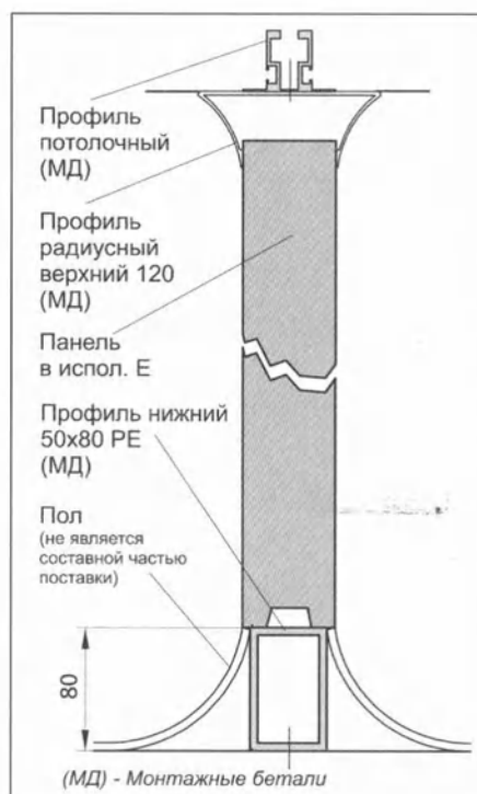
Рис.3 Крепление панели на профиле 50x80 РЕ
