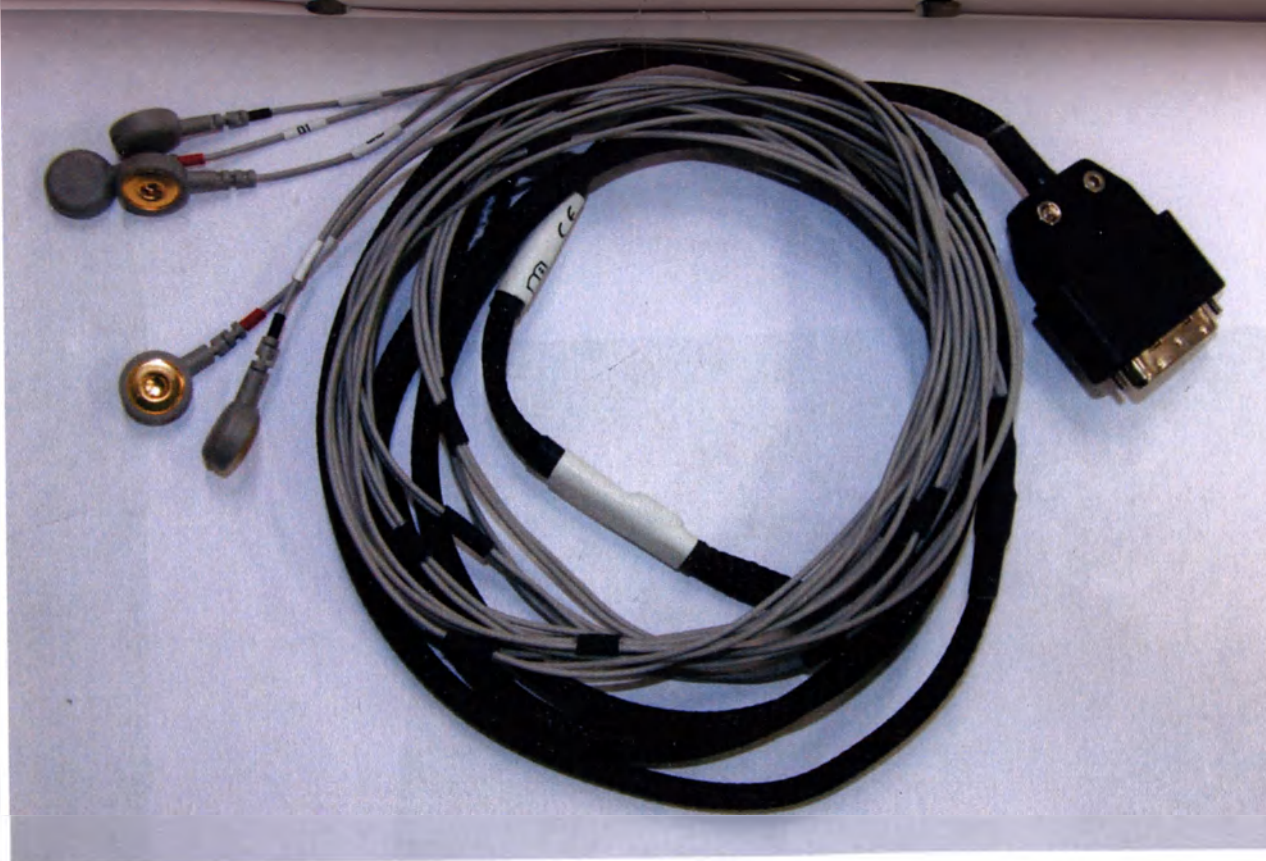
Адаптер для подключения поверхностных электродов к усилителю еего, ХЕ-292
