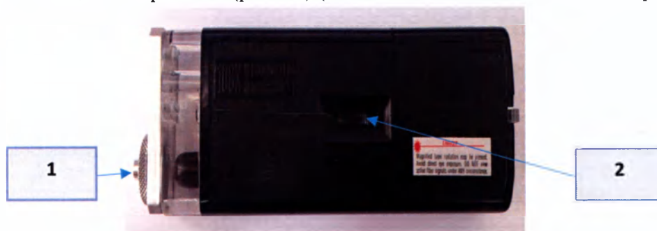
Рис. 12. Микроскоп для проверки торца инструмента волоконного в разъеме
