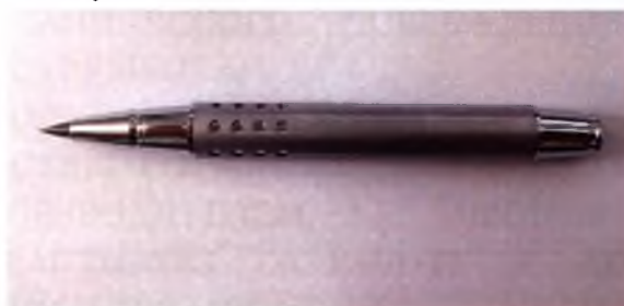
Рис. 11. Скалыватель волоконного инструмента
