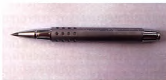
Рис. 11. Скалыватель волоконного инструмента
