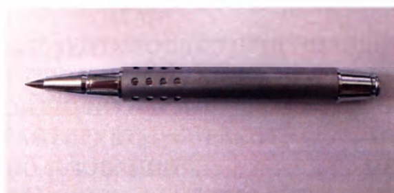
Рис. 11. Скалыватель волоконного инструмента
