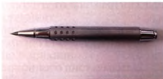
Рис. 11. Скалыватель волоконного инструмента
