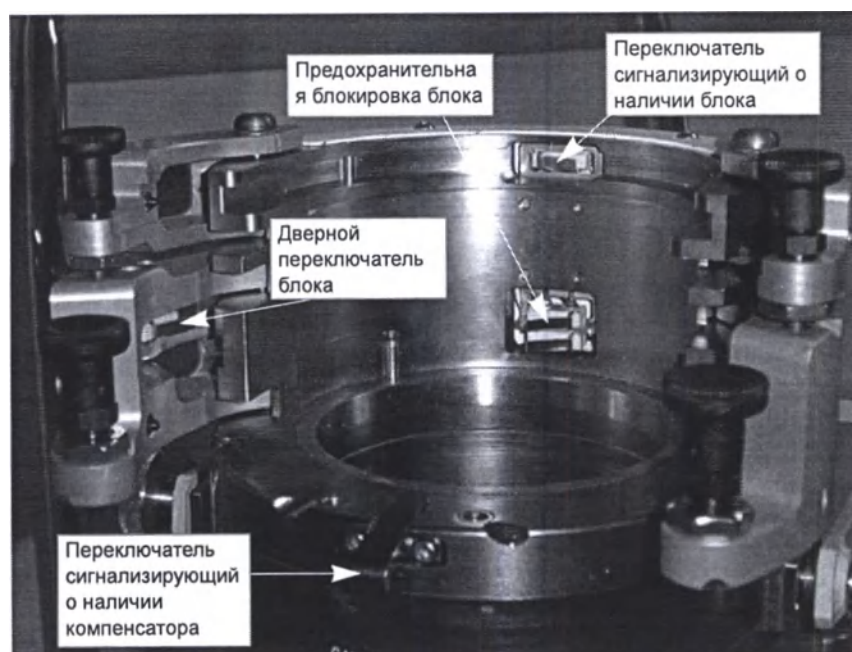
Рис. 14-1. Установка блока и компенсатора диапазона (наконечник сопла типа UN_S)
