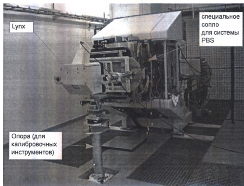
Рисунок А-1. Помещение для контроля качества установки с фиксированным пучком (FBQAR) (с установленными основным наконечником Lynx и калибровочными инструментами)
