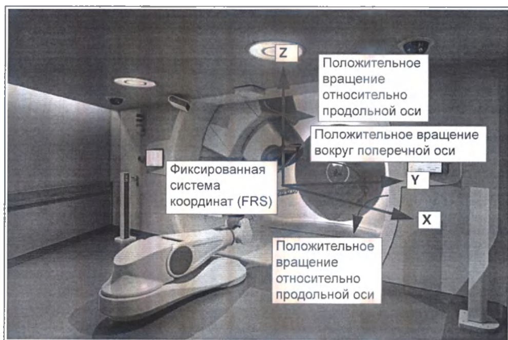
Рисунок 7-1. Схема расположения оборудования в помещении GTR
