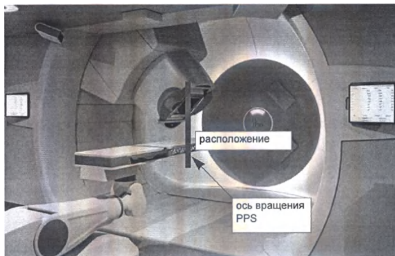
Рисунок 17-1. Расположение фантома Water Phantom в системе PPS (типичное)
