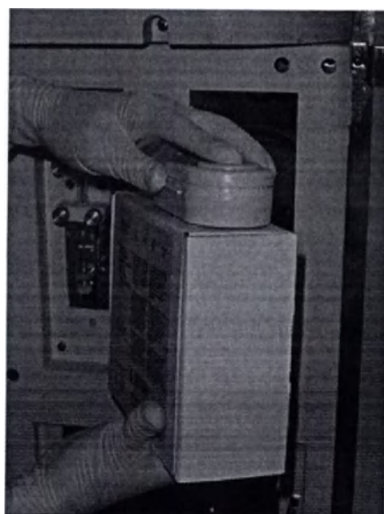
Figure 12.5 Установка пакета реагентов (модуля реагентов) 2
