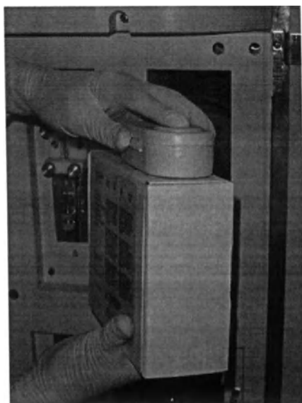
Figure 12.5 Установка пакета реагентов(модуля реагентов) 2
