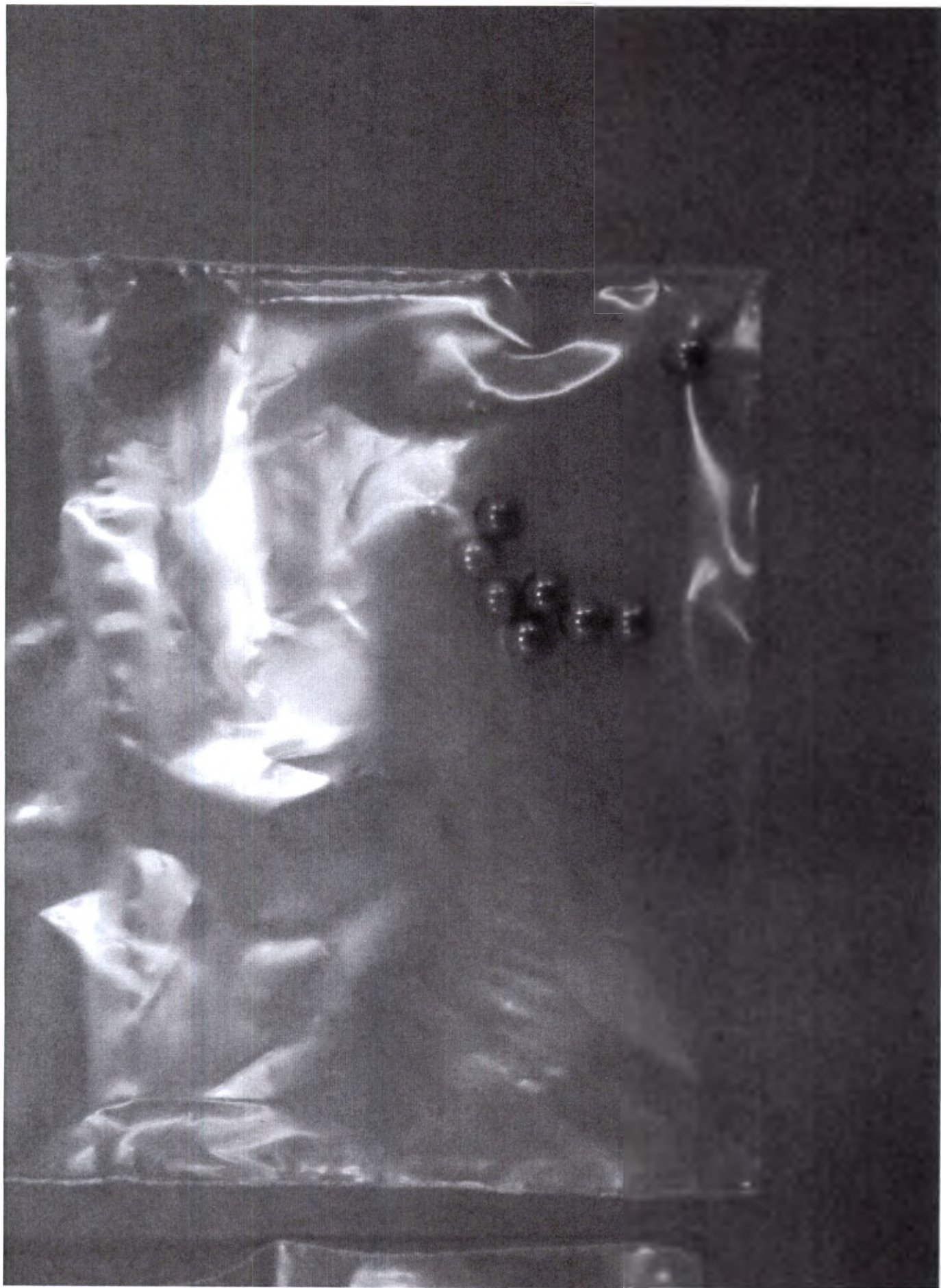
Рис 25. - Шарик калибровочный Ø5 мм
