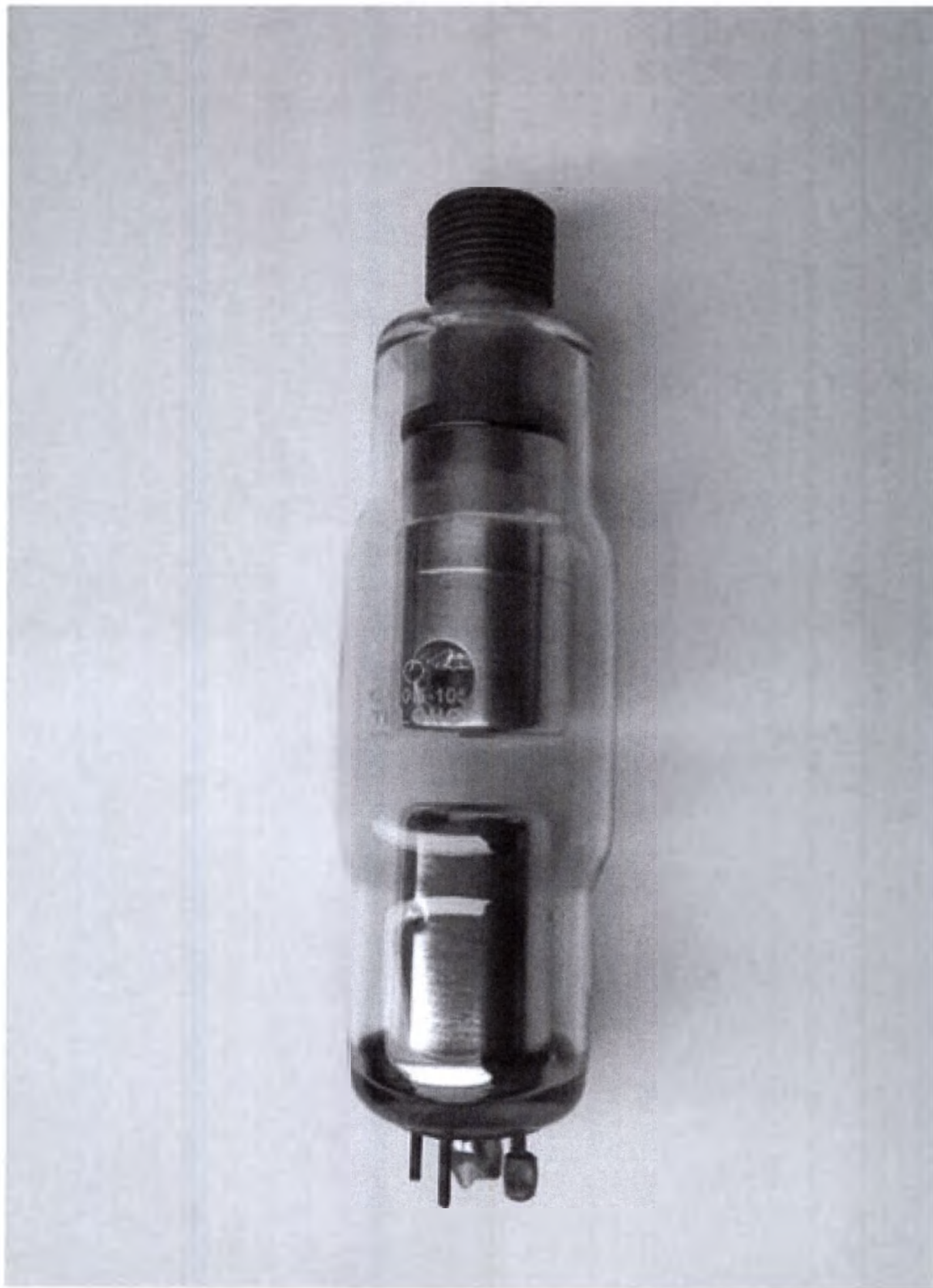
Рис 2. - Трубка рентгеновская производства фирмы CEI модели OPX-105
