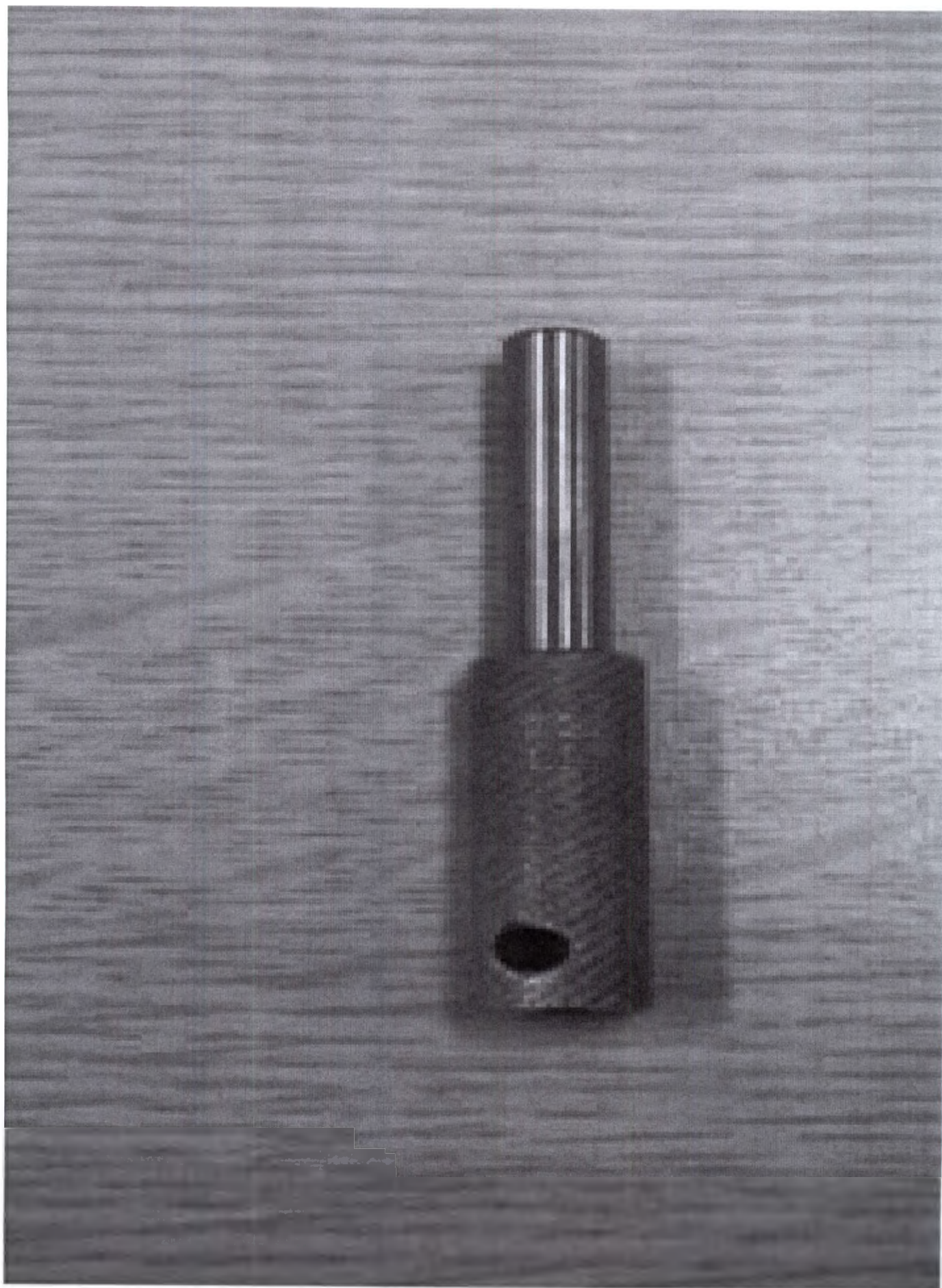
Рис 37. - Тест-объект " Pin Jig"
