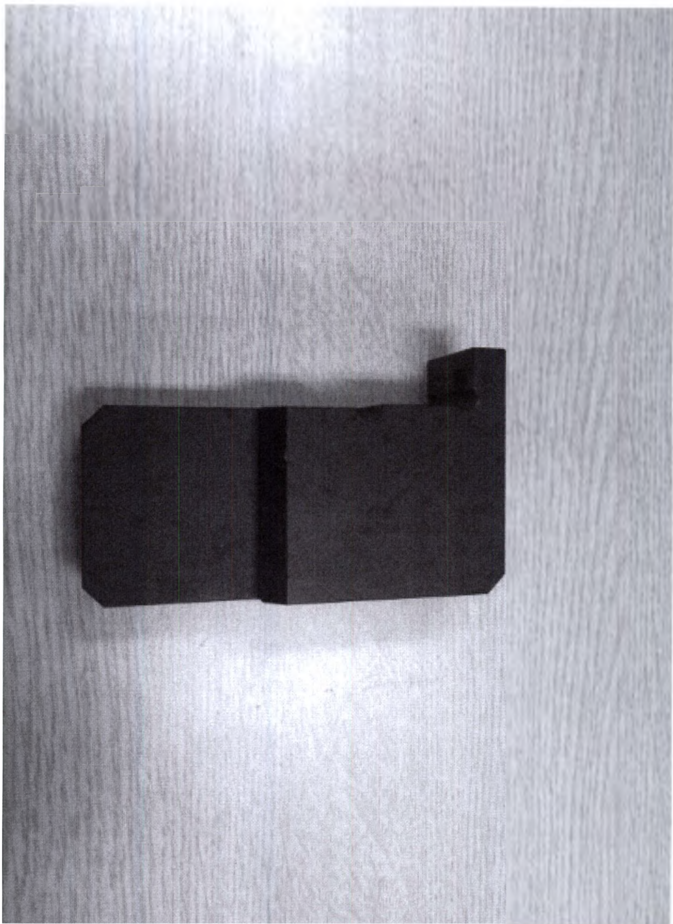
Рис 34. - Тест-объект "Theta Jig"
