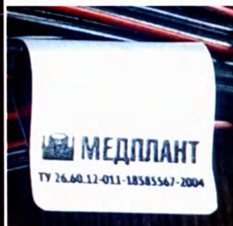
Кабель для подключения внешнего питания 12 В (Модель 1) и его маркировка
