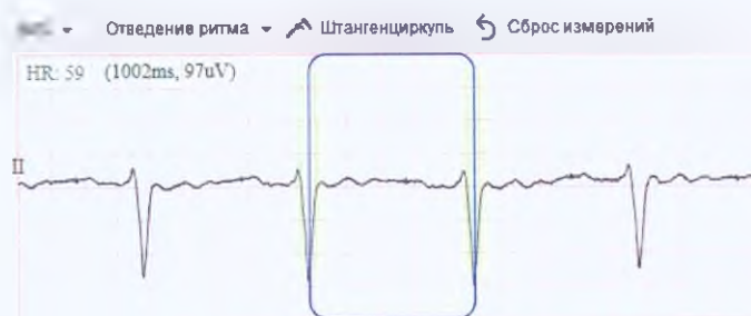
Активация инструмента штангенциркуль и отображенные измерения
