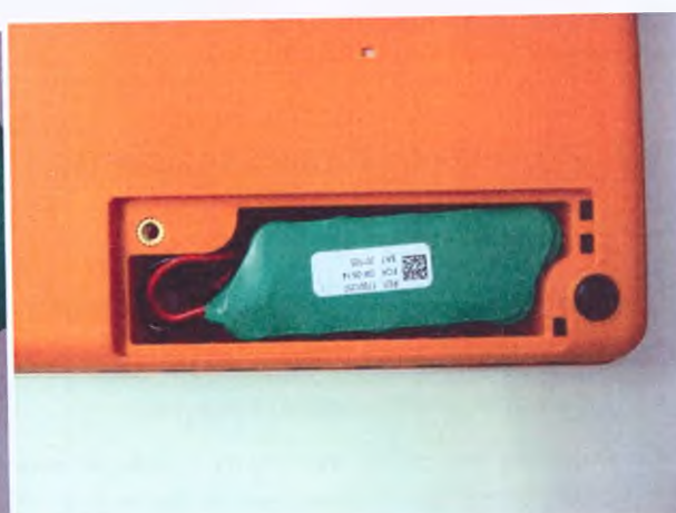
4. Разместить аккумулятор в отсеке.
