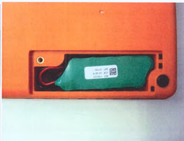
4. Разместить аккумулятор в отсеке.
