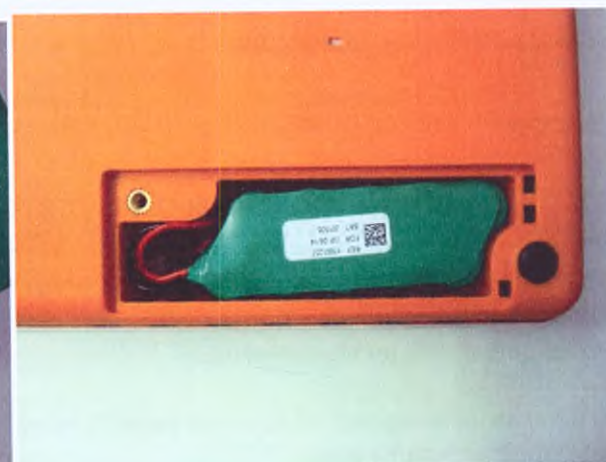
4. Разместить аккумулятор в отсеке.
