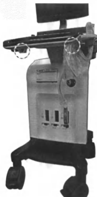
Рис. 1-23. Подключения кабеля датчика
