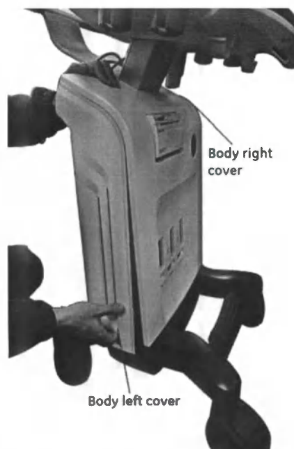
Рис. 3-24. Снятие левой панели корпуса системы
